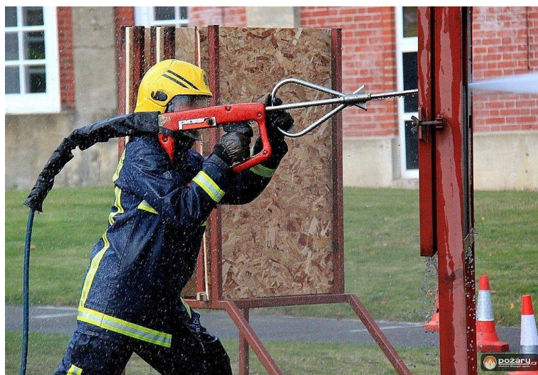
Sl. 35. CCS Cobra - sistem za gašenje i rezanje visokim tlakom
