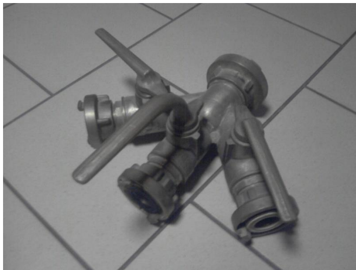
Sl. 19. Trodijelna razdjelnica visokog tlaka
