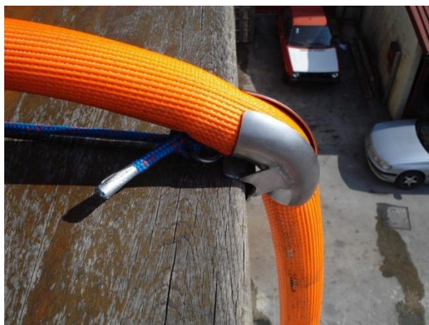
Sl.30. Koljeno za smanjenje opterećenja
