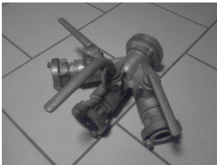
Sl. 19. Trodijelna razdjelnica visokog tlaka
