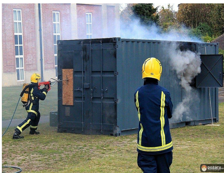
Sl. 36. Simulacija gašenja CCS Cobrom
