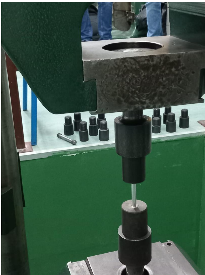
Slika 8. Položaj epruvete u kidalici prije ispitivanja
