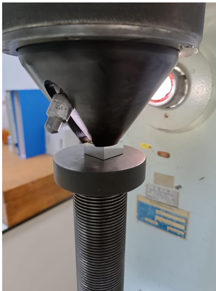
Slika 12. Pozicija uzorka na tvrdomjeru
