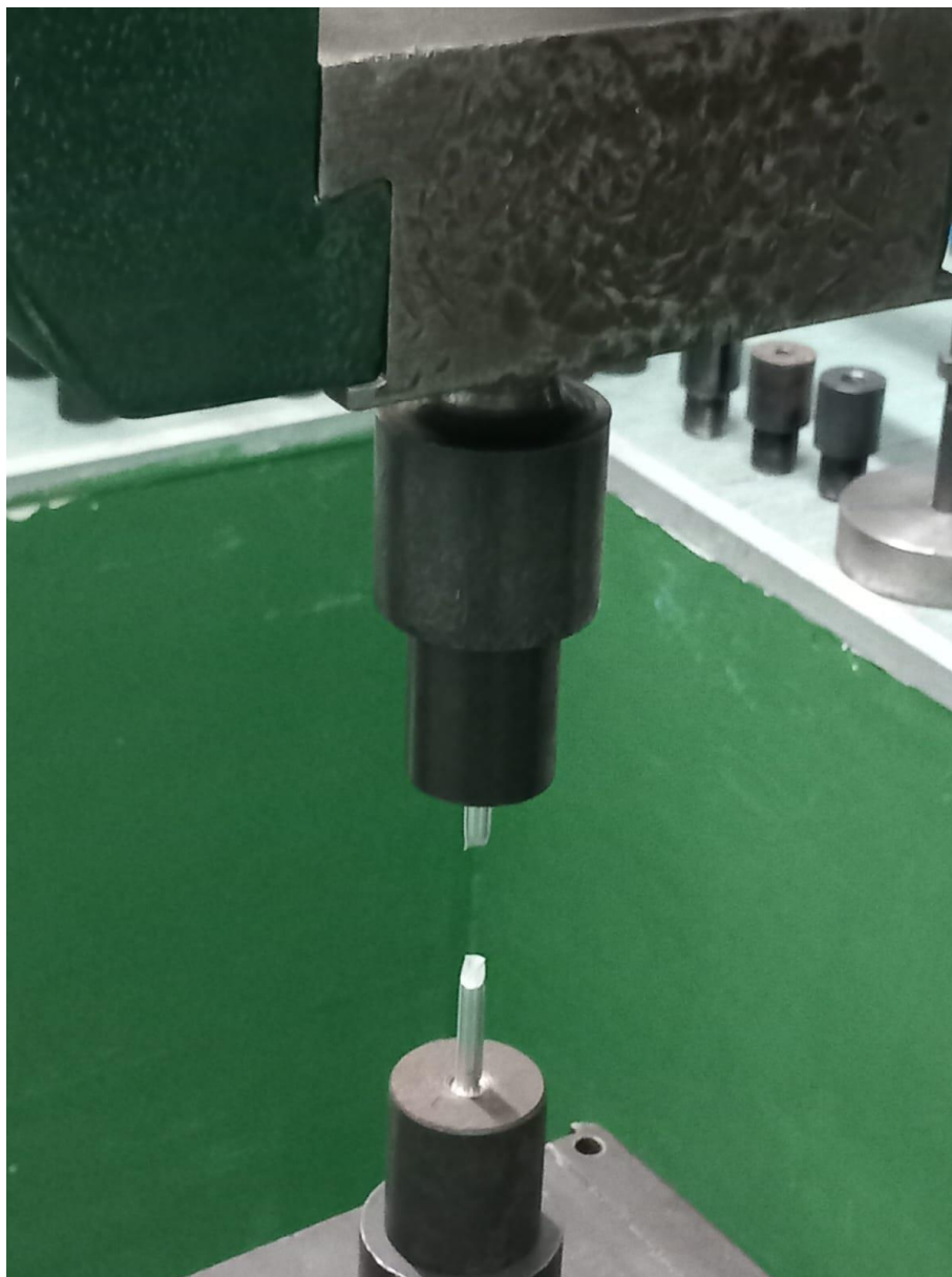
Slika 9. Položaj puknuća epruvete u kidalici
