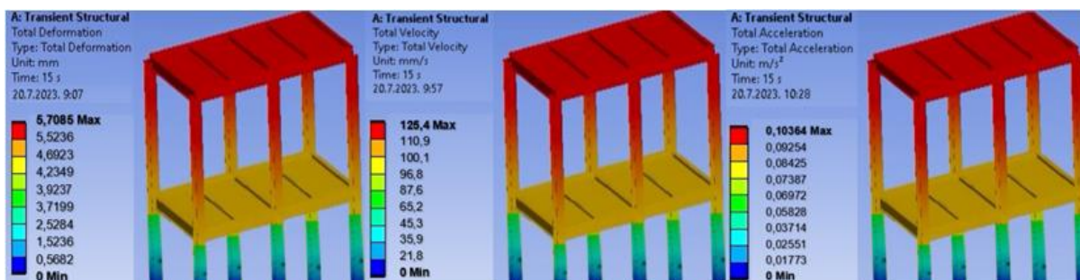
Slika 7. Rezultati analize police u potresu
