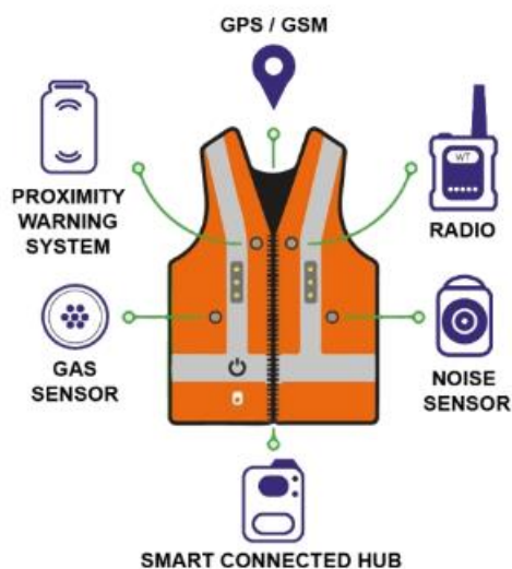
Slika 9. Zaštitni prsluk sa sensorima [16]
