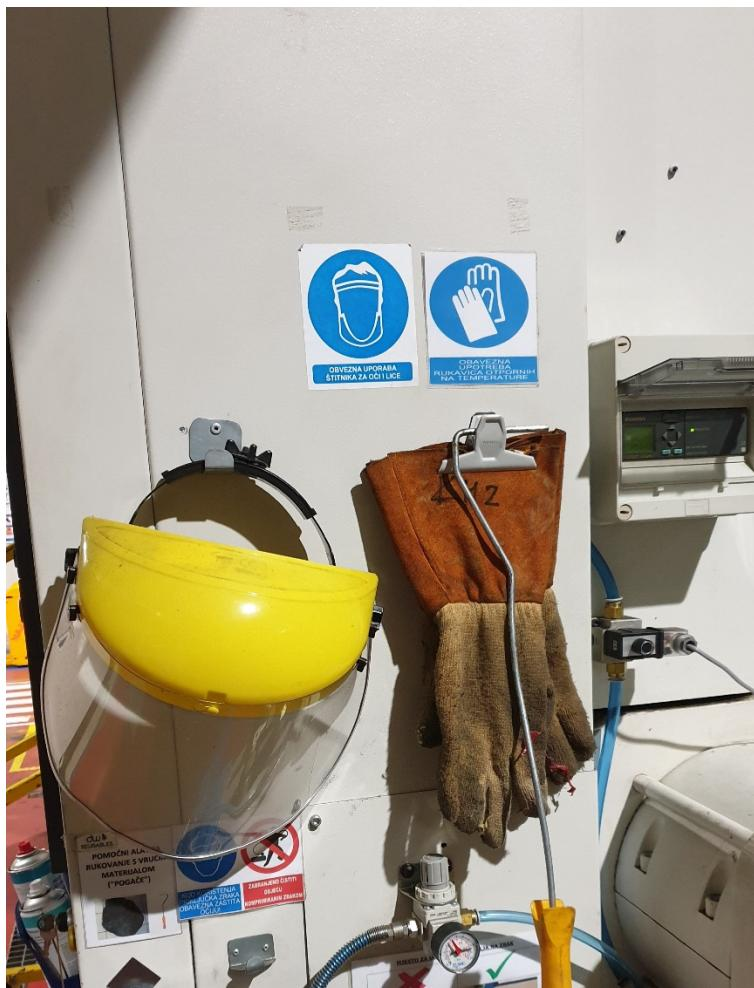
Slika 14. Zaštitni vizir i rukavice otporne na visoku temperaturu
