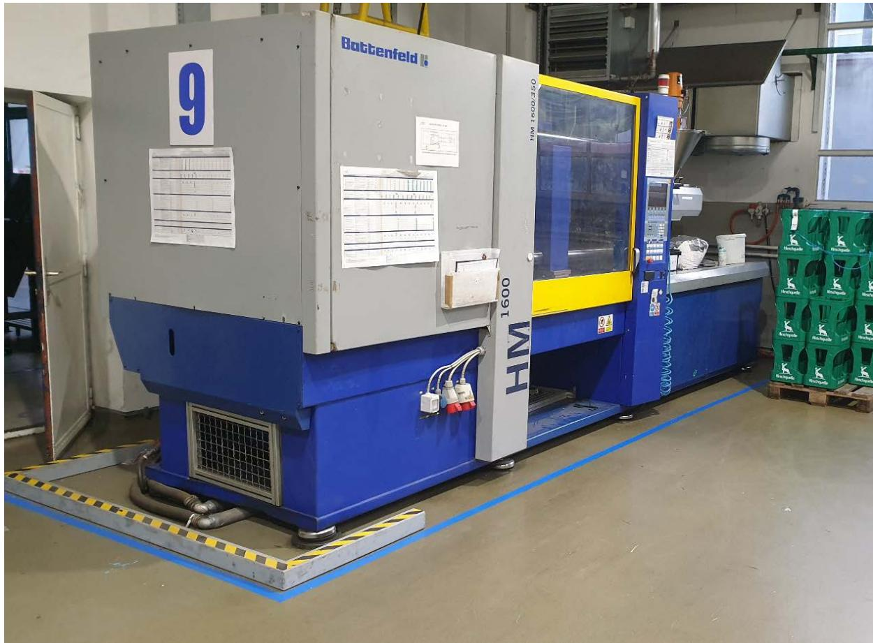
Slika 3. Stroj za injekcijsko prešanje Battenfeld
