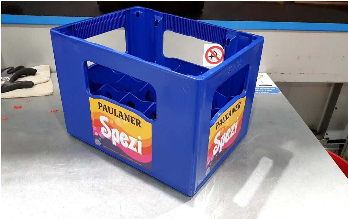
Slika 12. Nosiljka za boce izrađena injekcijskim prešanjem
