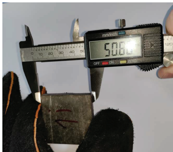
Slika 31.: Provjera prve dimenzije na obratku
