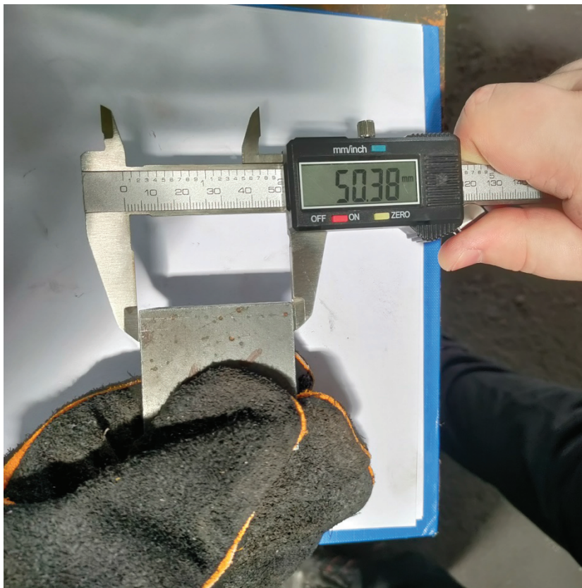
Slika 25.: Mjerenje prve dimenzije uz pomoć pomičnog mjerila
