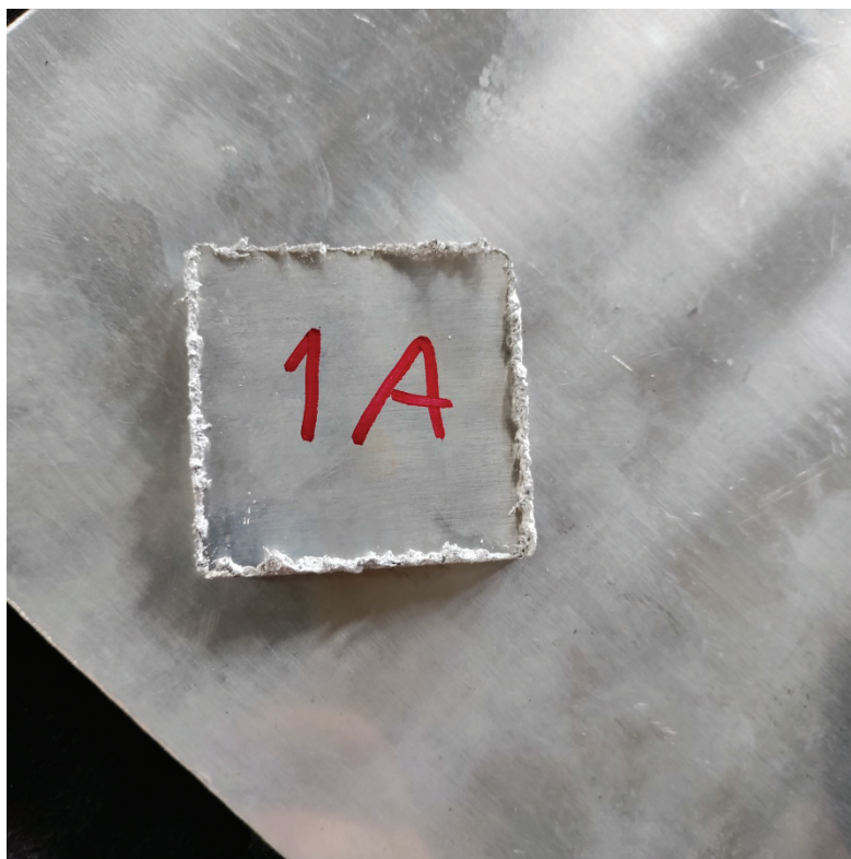
Slika 38.: Prvi izrezani obradak iz aluminijskog lima
