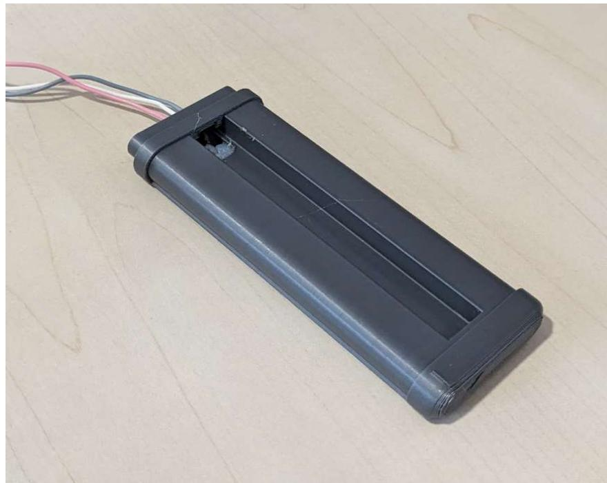
Slika 36 Tijelo stupa sa H senzorom [8]
