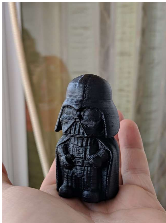
Slika 8 Figura Ispisana FDM tehnologijom [8]
