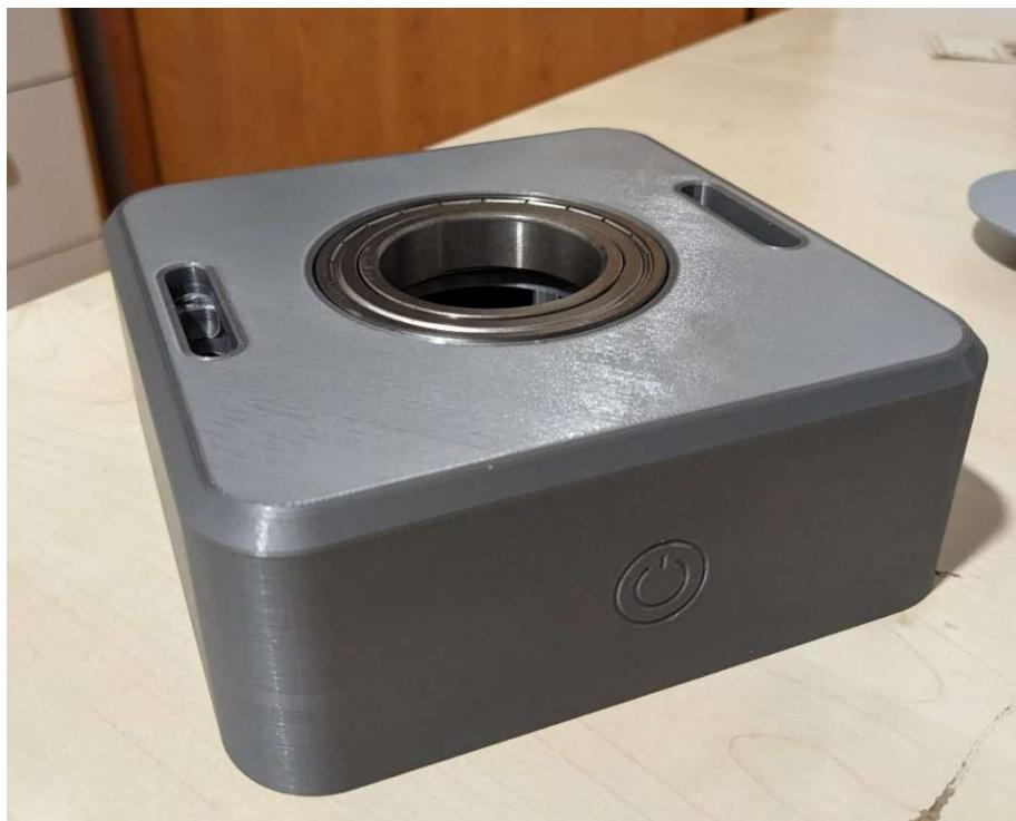
Slika 39 Tijelo kućišta s ležajem [8]
