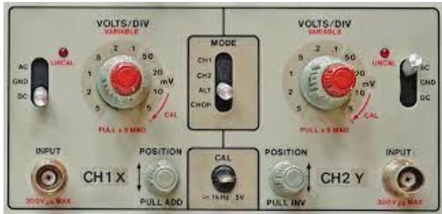
Slika 4: Kontrole sustava za vertikalni otklon analognog osciloskopa [3]
