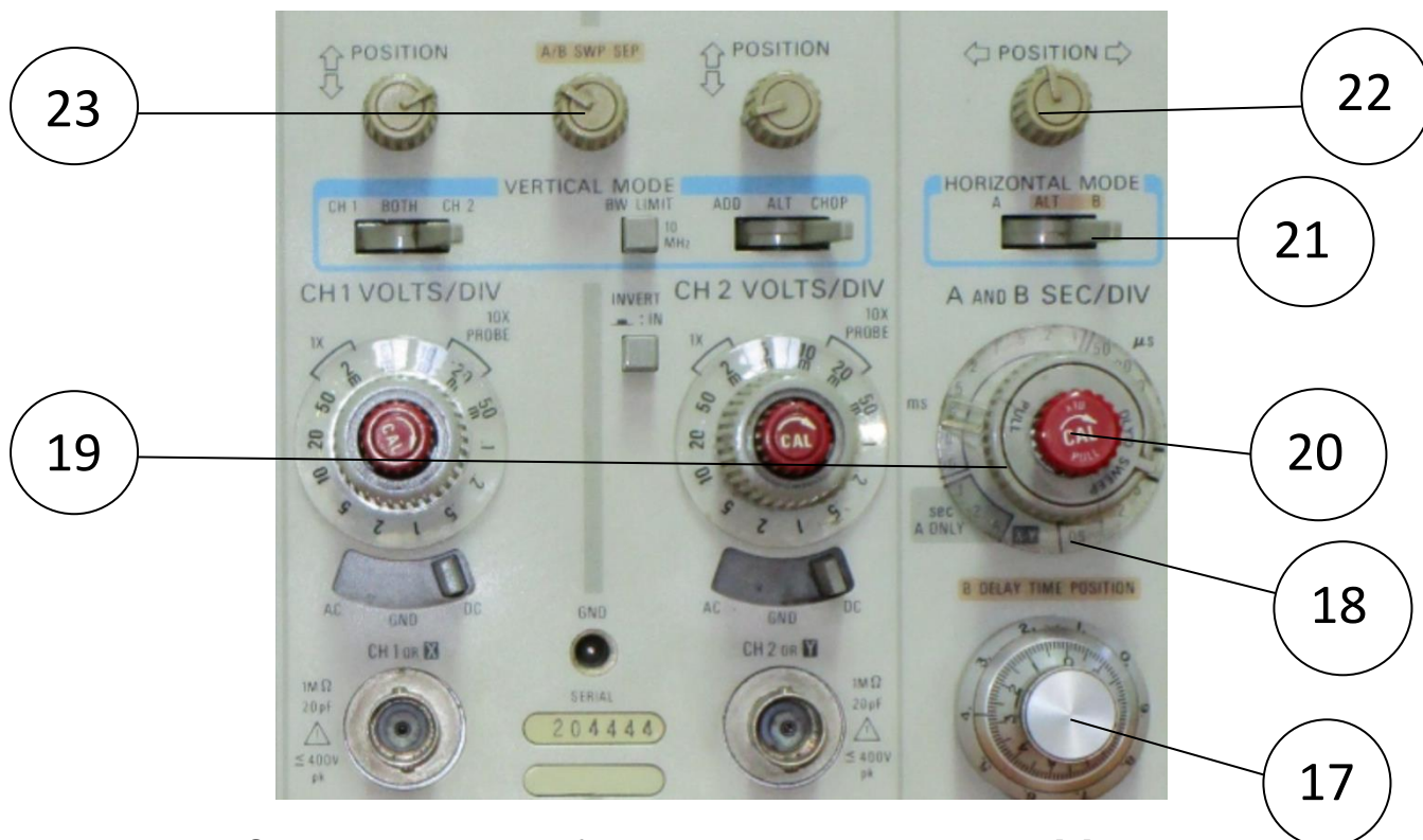
Slika 9 : Horizontalne funkcije analognog osciloskopa [5]
