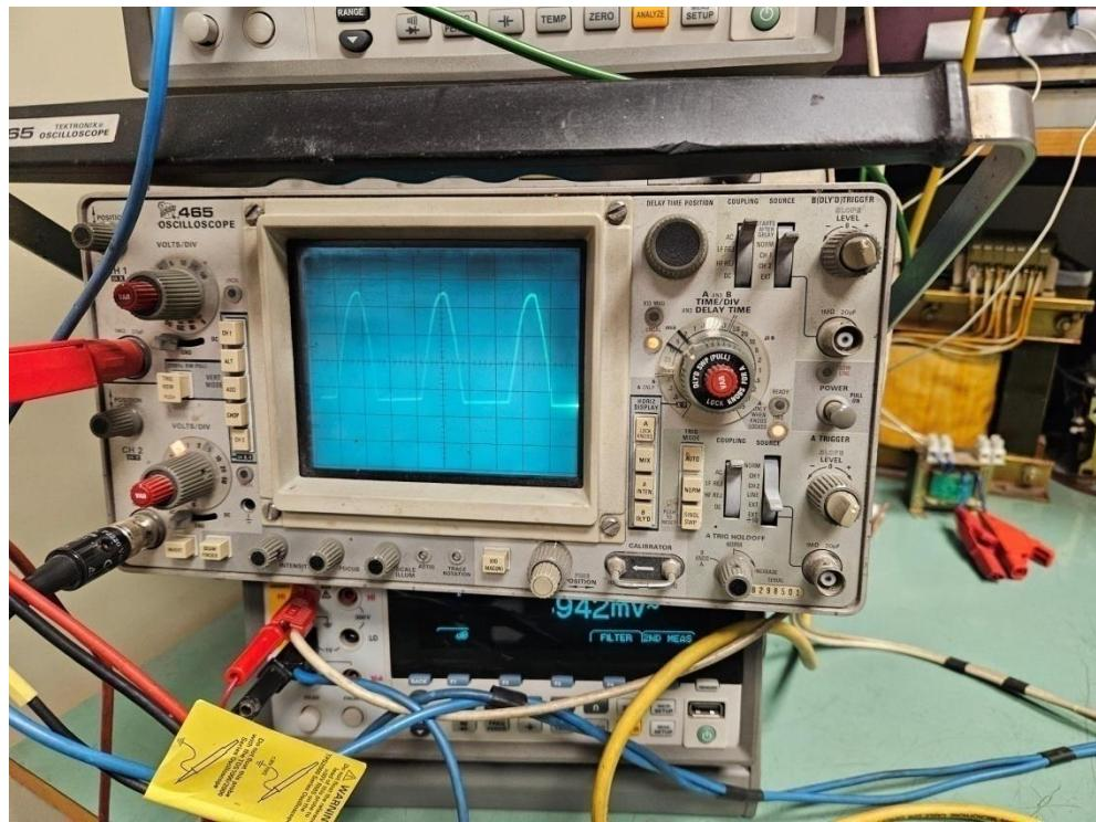
Slika 24: Signal poluvalnog ispravljača sa analognim osciloskopom
