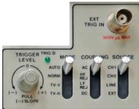
Slika 6: Okidni sustav analognog osciloskopa [3]
