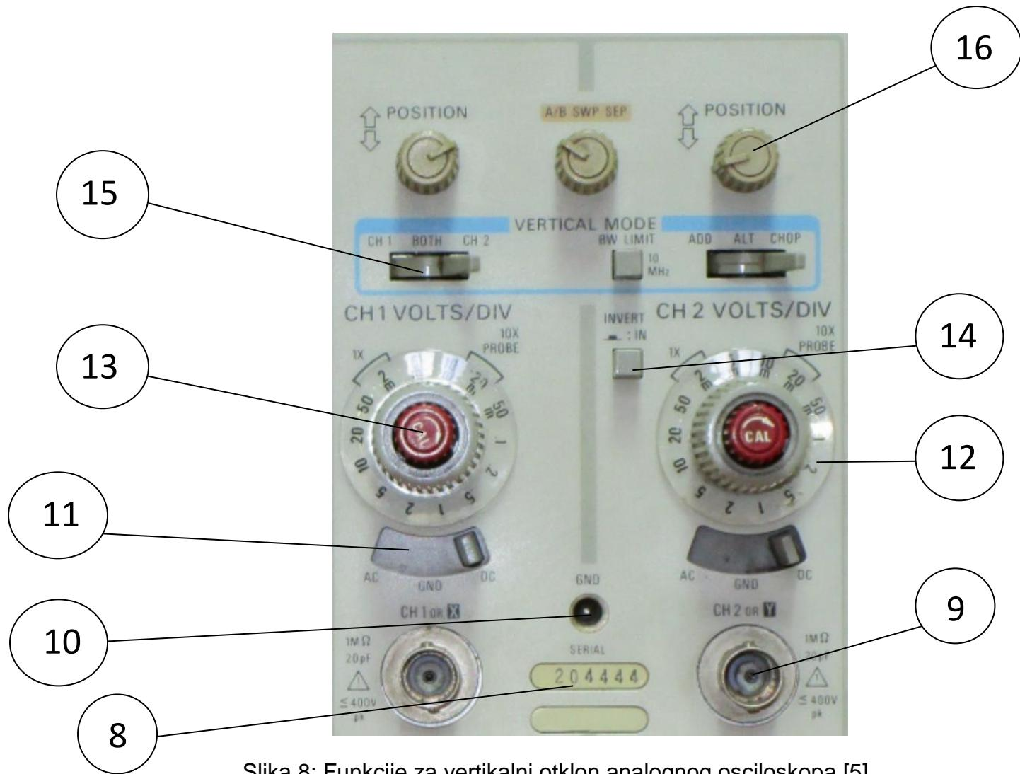
Slika 8: Funkcije za vertikalni otklon analognog osciloskopa [5]
