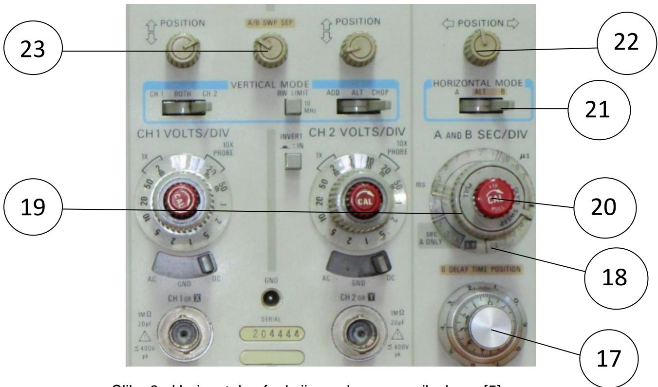
Slika 9 : Horizontalne funkcije analognog osciloskopa [5]
