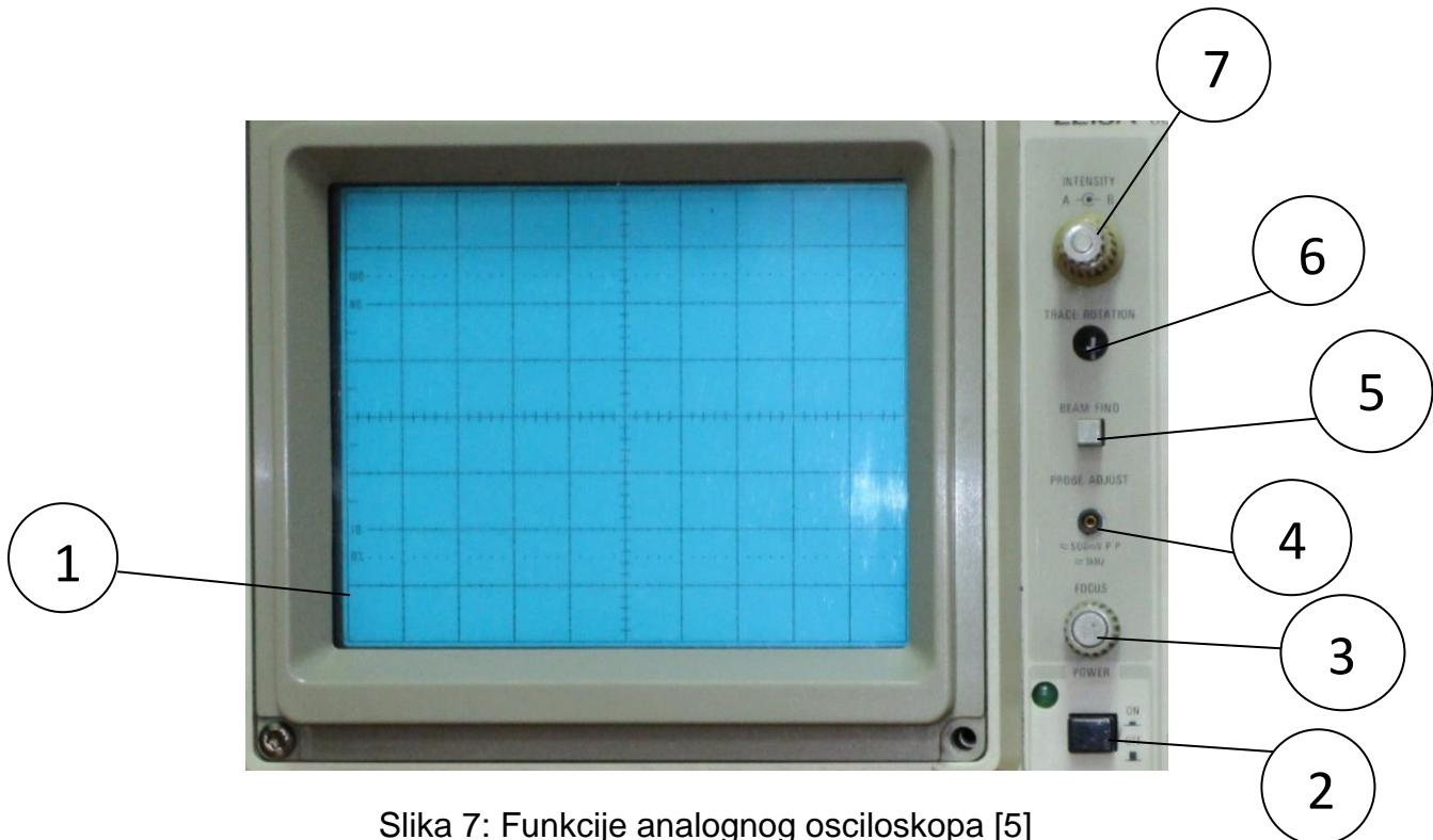
Slika 7: Funkcije analognog osciloskopa [5]
