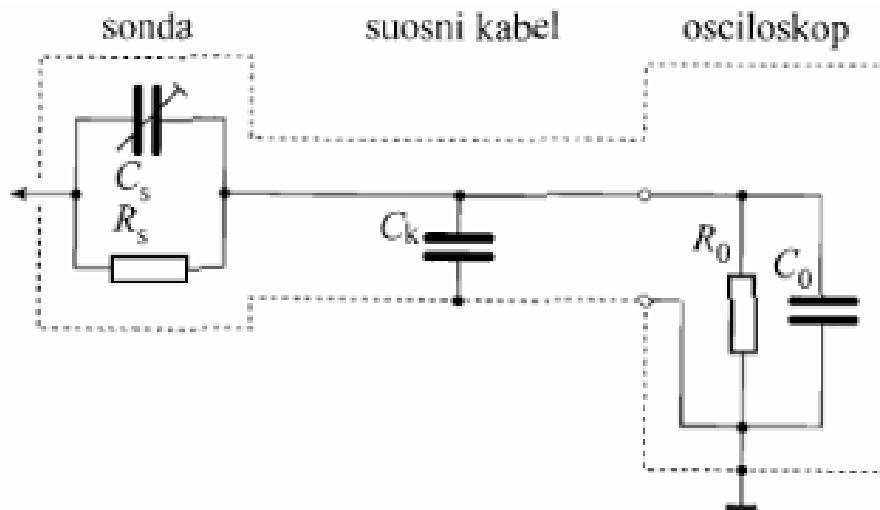
Slika 20: Shema osciloskopske sonde [7]
