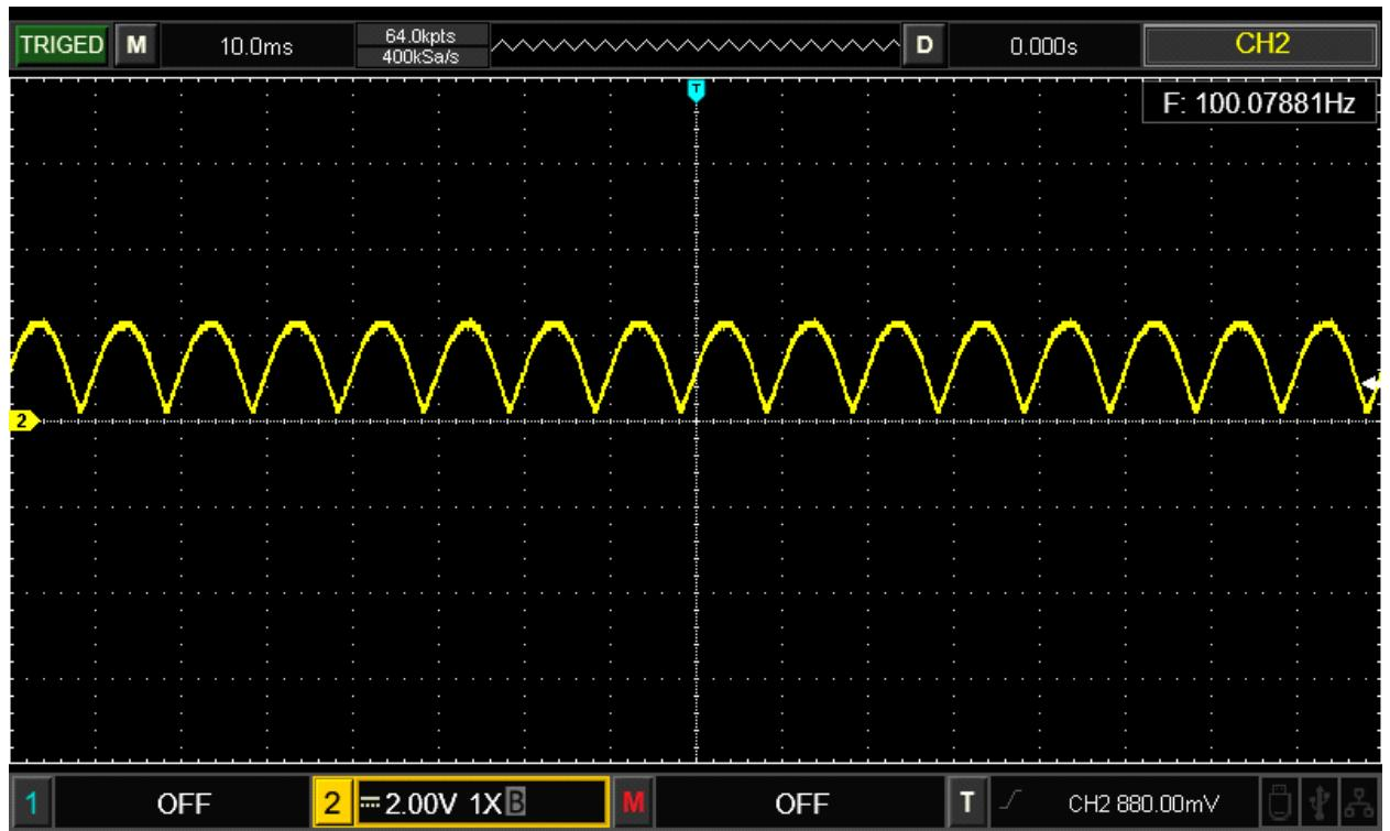
Slika 27: Signal punovalnog ispravljača sa digitalnim osciloskopom
