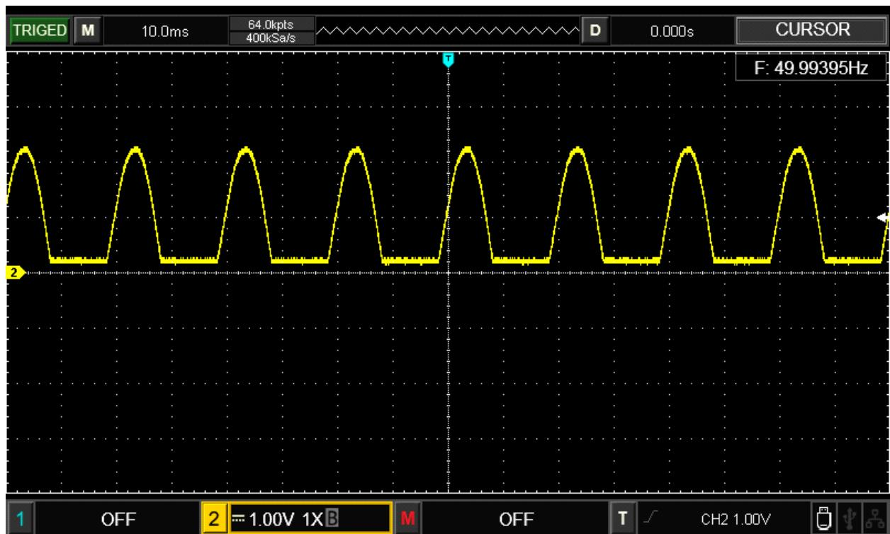
Slika 23: Signal poluvalnog ispravljača sa digitalnim osciloskopom
