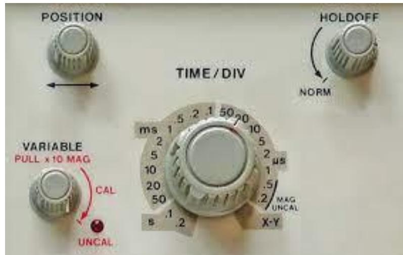
Slika 5: Kontrole sustava za horizontalni otklon analognog osciloskopa [3]
