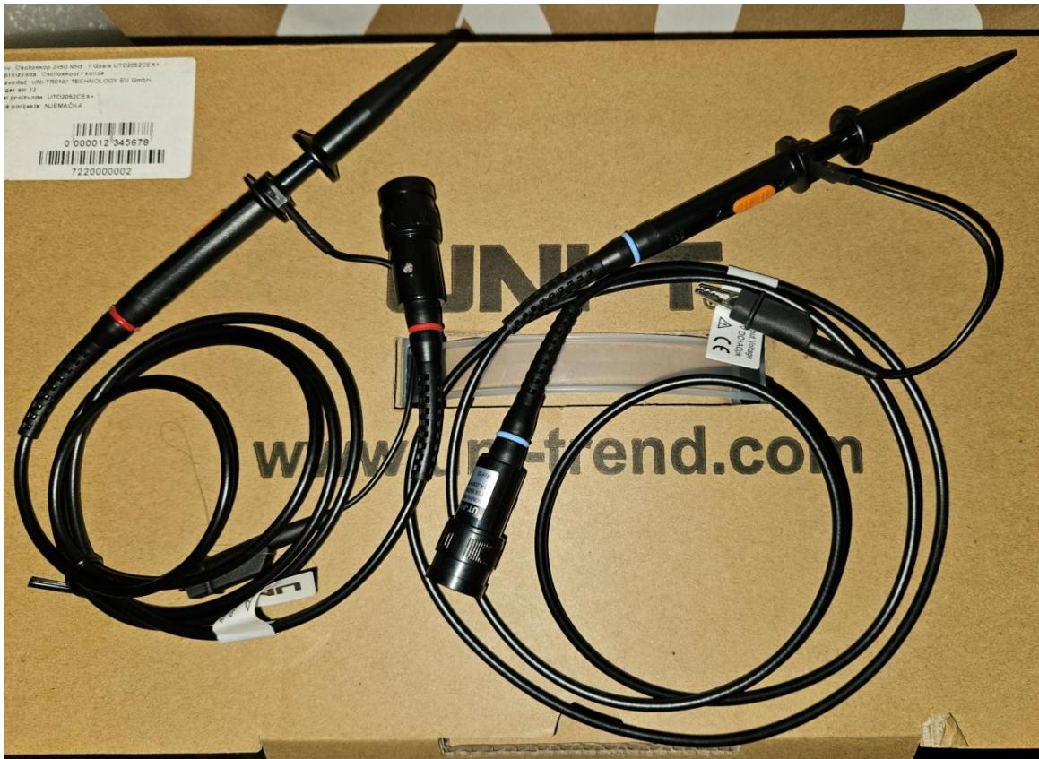
Slika 19: Osciloskopska sonda
