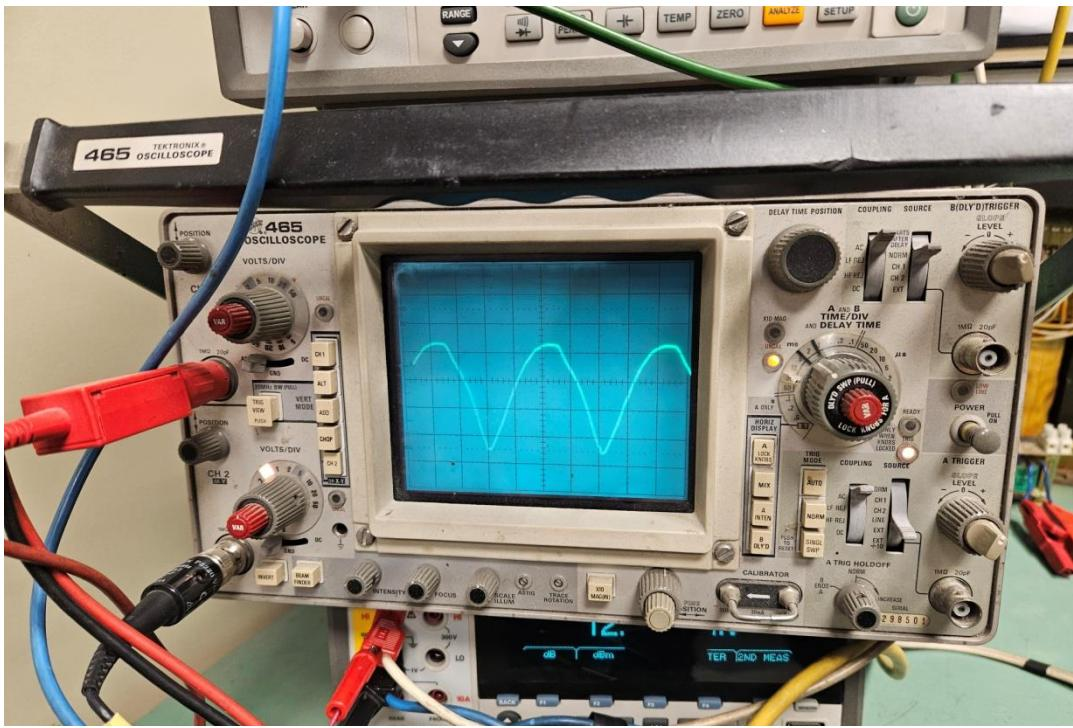
Slika 26: Signal punovalnog ispravljača sa analognim osciloskopom
