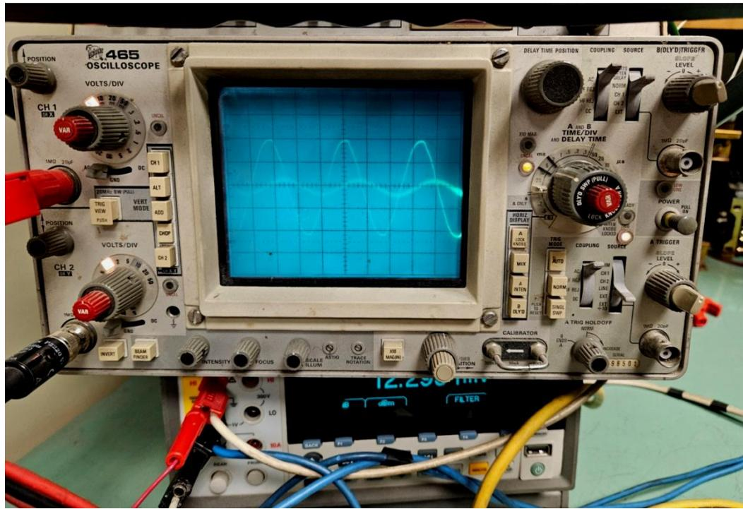
Slika 30: Signal RC kruga sa analognim osciloskopom
