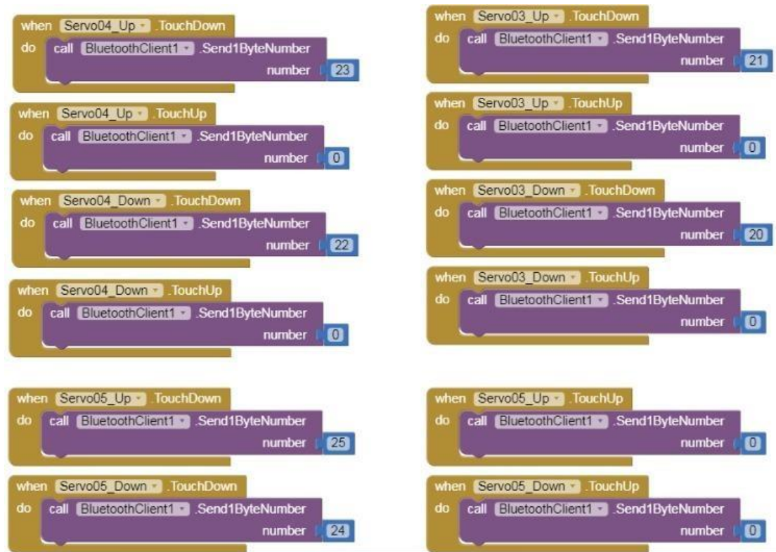
Slika 24: Blokovi za kontrolu servo motora
