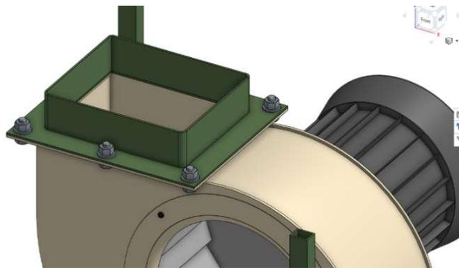
**Slika 48. Prirubna ploča spojena vijcima, maticom i podloškama**
