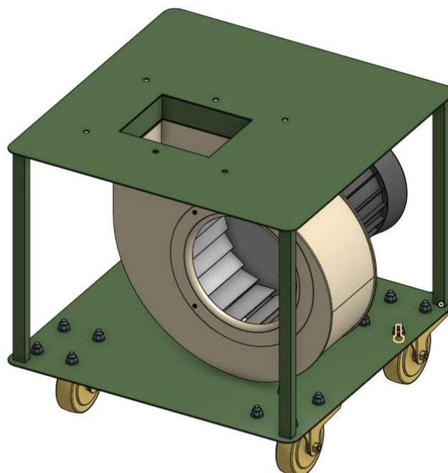
**Slika 49. Kolica ventilatora**
