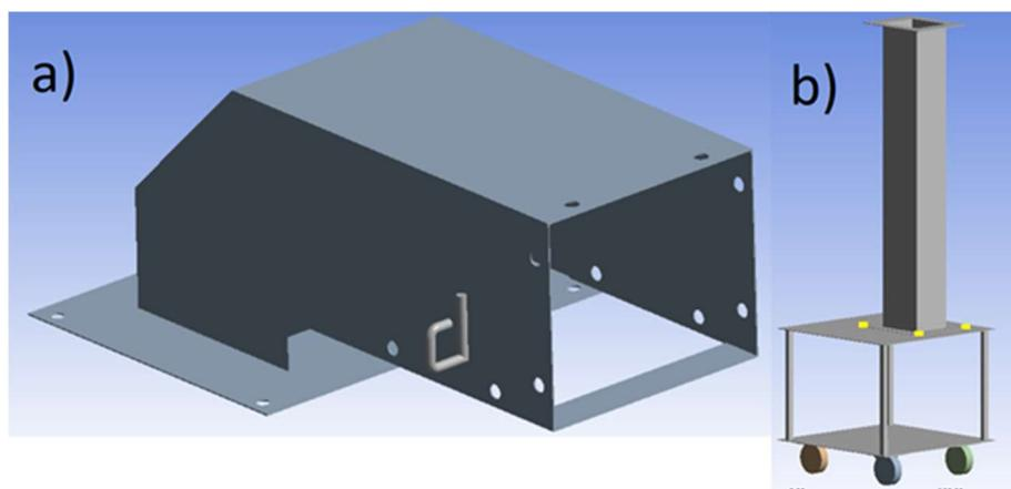
Slika 54. a) Ventilacijski poklopac. b) Okvirna konstrukcija s ventilacijskim kanalom.
