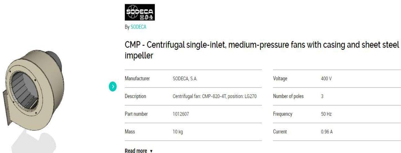
Slika 47. 3D model ventilatora [22]
