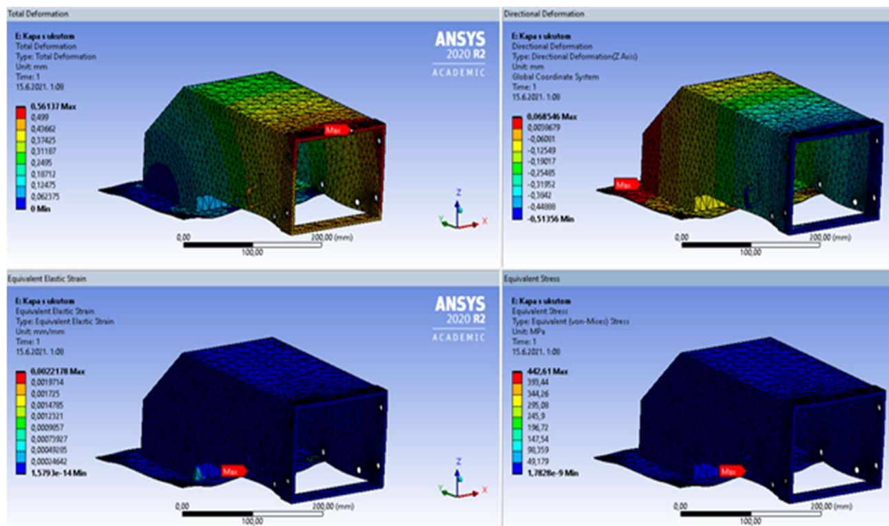
Slika 57. Rezultati proračuna ventilacijskog poklopca
