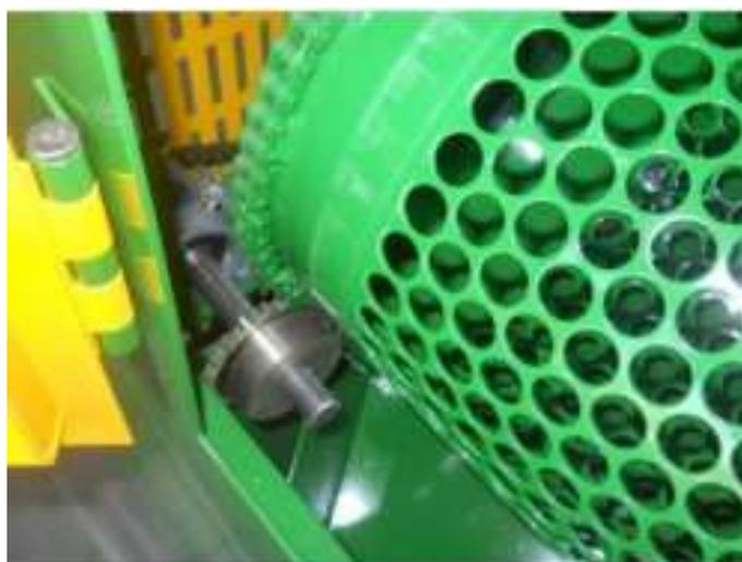
Slika 7. Limeni bubanj za urezanim profilima [4]
