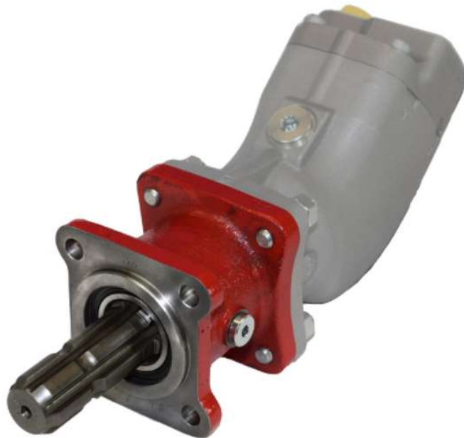
Slika 45. Pogled spojenog adaptera sa pumpom [20]
