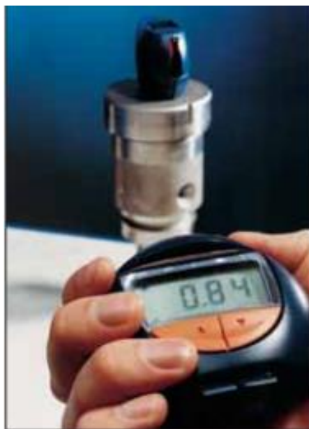
Slika 40. Surtronic Duo koristi infracrvenu (IrDA) vezu između gornje i donje jedinice kako bi omogućio bežično, udaljeno upravljanje na udaljenost do jednog metra, bez potrebe za kablovima. [15]
