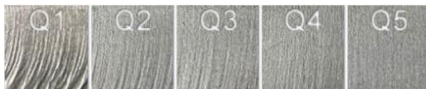
Slika 29. Različite hrapavosti površine nakon obrade vodenim mlazom [12]
