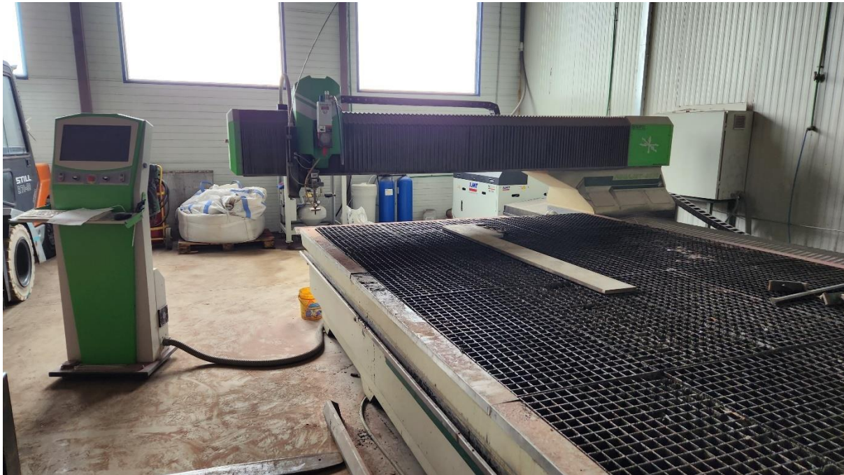
Slika 34. Radni stol, mlaznica i upravljačka jedinica
