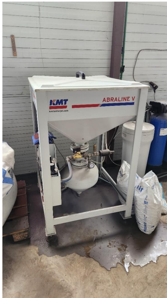
Slika 38. Uređaj za kontinuirano dovođenje abraziva
