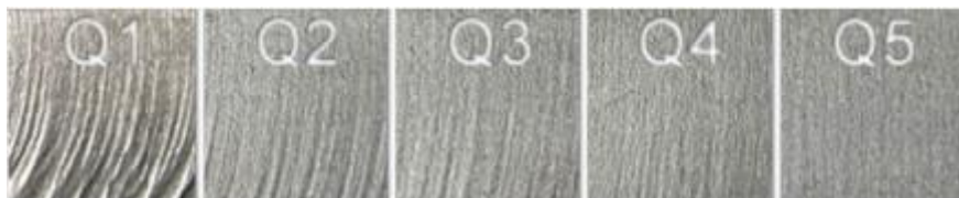
Slika 29. Različite hrapavosti površine nakon obrade vodenim mlazom [12]
