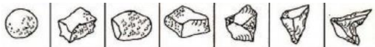
Slika 12. Različiti oblici abrazivnih sredstava [5]
