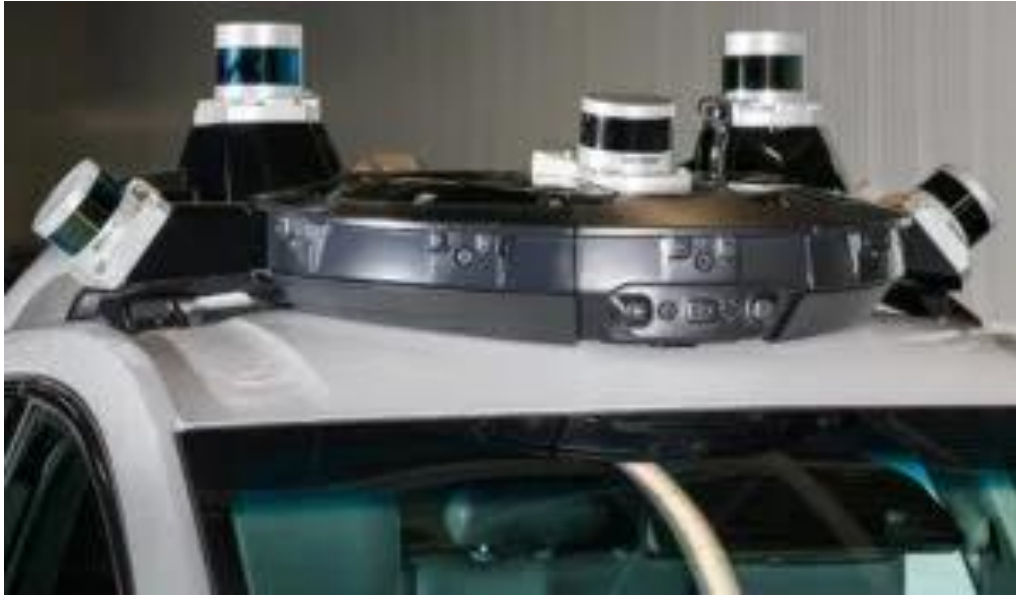
Slika 6. Predodžba položaja lidara na vozilu. Izvor [6].
