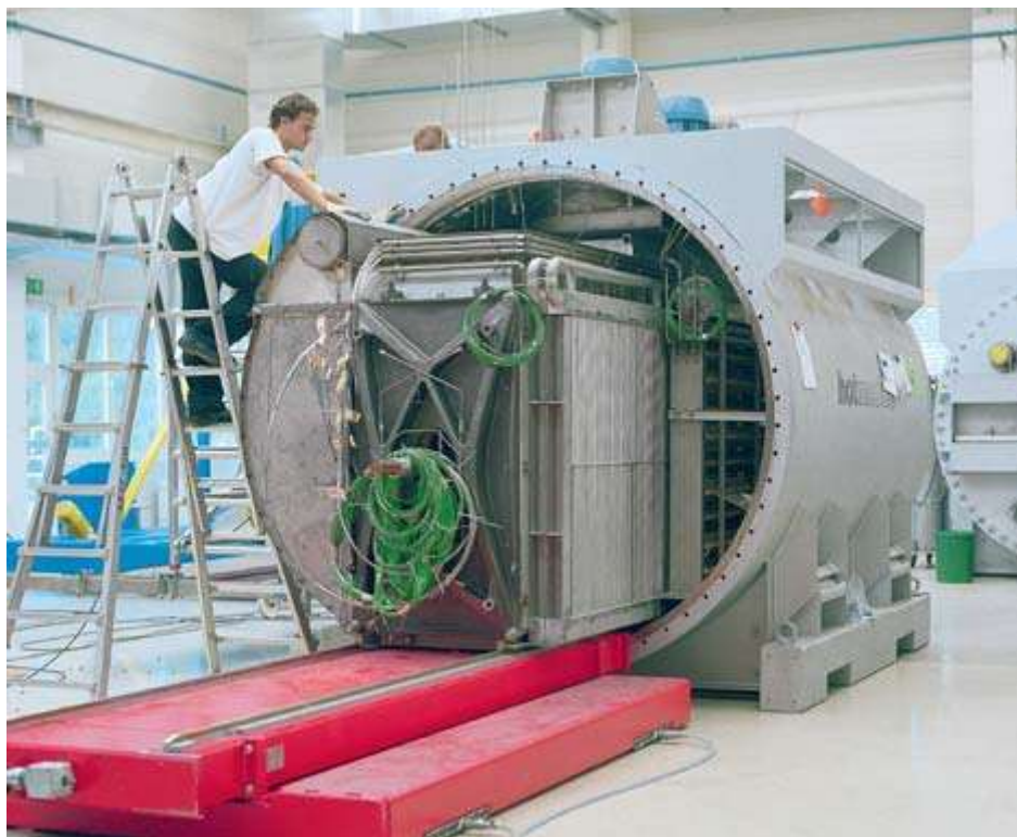
Slika 11. Goriva ćelija s rastaljenim karbonatima
