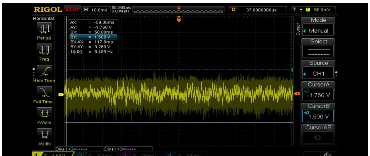
Slika 24. Predodžba audio signala na izlazu iz pojačala
