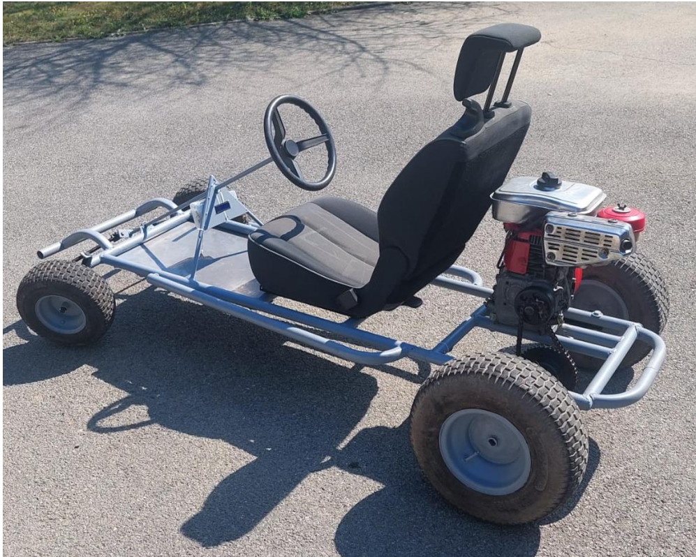
Slika 39 Izrađen Go-kart [Izvorno autor]
