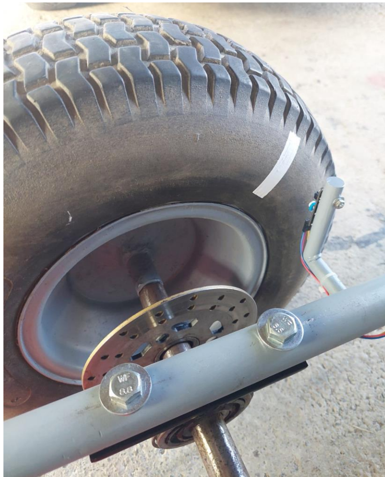
Slika 32 Postavljen IR senzor [Izvorno autor]
