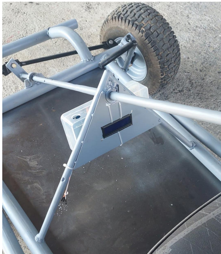
Slika 36 Postavljen sustav za mjerenje brzine [Izvorno autor]
