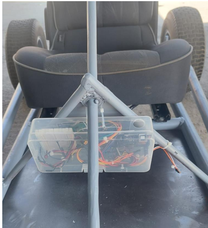
Slika 35 Postavljen sustav za mjerenje brzine [Izvorno autor]
