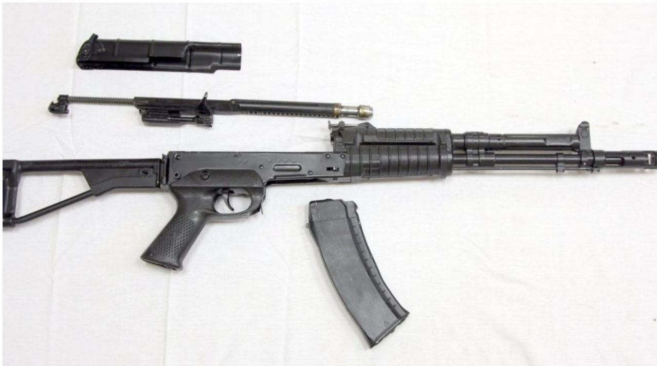
Slika 22 AK-107 sa izvađenim mehanizmom balansiranja [22]
