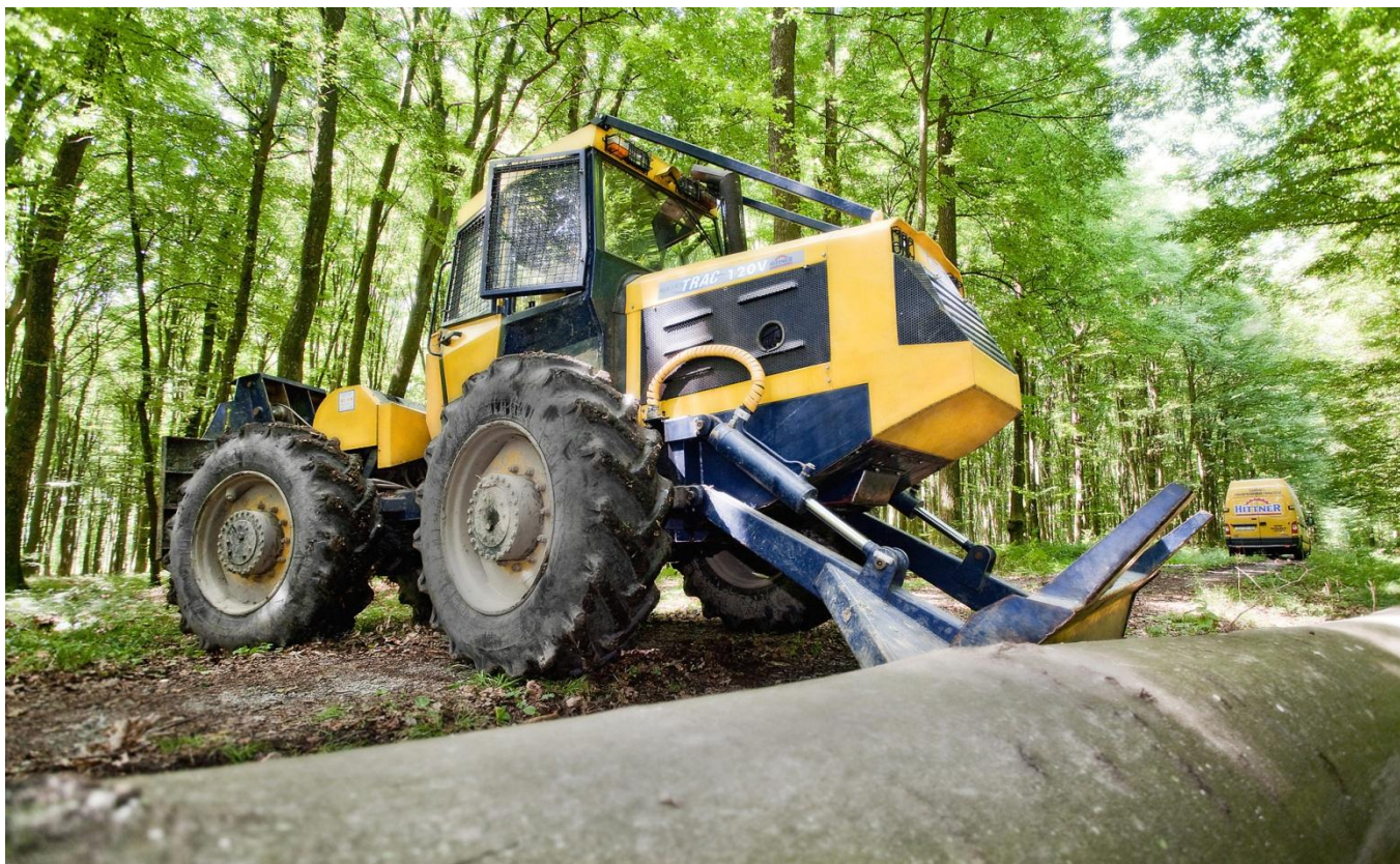
Slika 1. Izvlačenje drvnih sortimenata pomoću Hittnera
