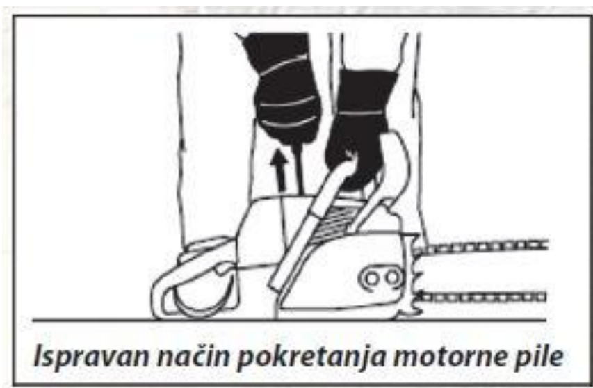
Slika 5. – Ispravan način pokretanja motorne pile
