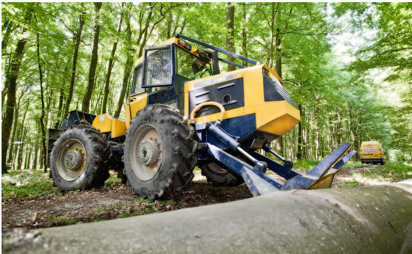
Slika 1. Izvlačenje drvnih sortimenata pomoću Hittnera
