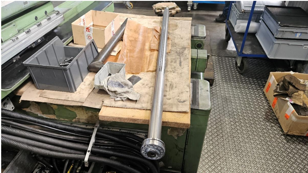
Slika 21. Vreteno za pokretanje pinole[Autor]
