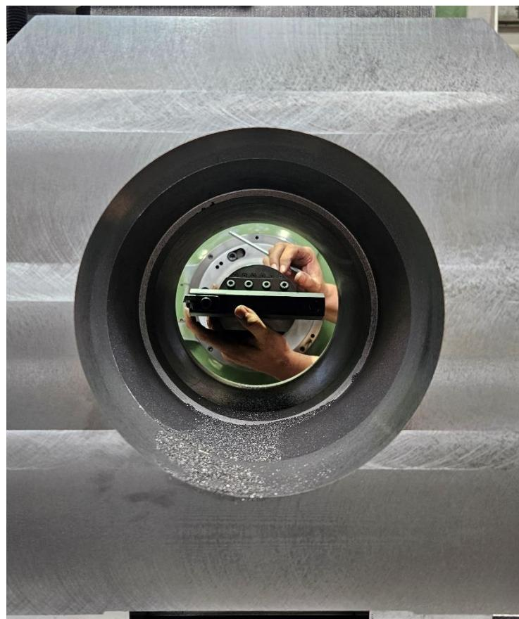
*Slika 53. Priprema alata za završnu obradu na mjeru[Autor]*
