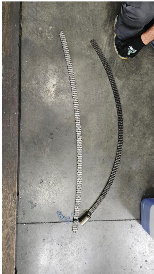
Slika 36. Novi i stari lanac[Autor]
