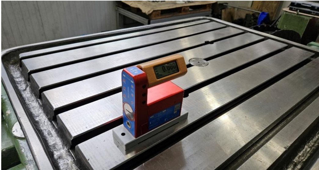
Slika 39. Mjerni instrument za provjeru ravnosti stroja[Autor]
