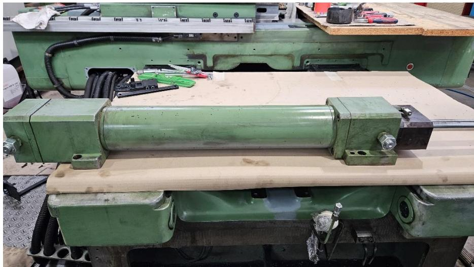
Slika 25. Hidraulički cilindar[Autor]
