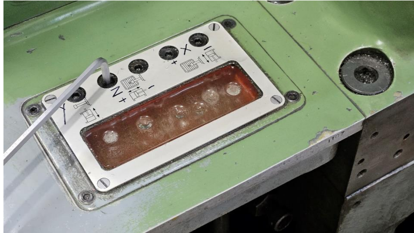
Slika 37. Ozračivanje hidrauličkih cilindara[Autor]
