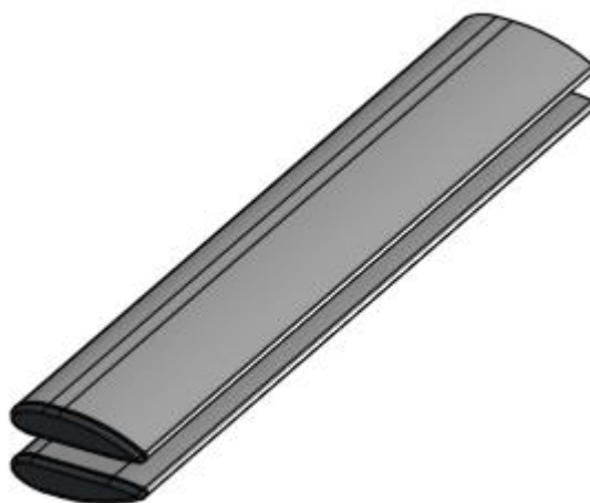
Slika 1.5 Preklopni krovni nosač u sklopljenom stanju
