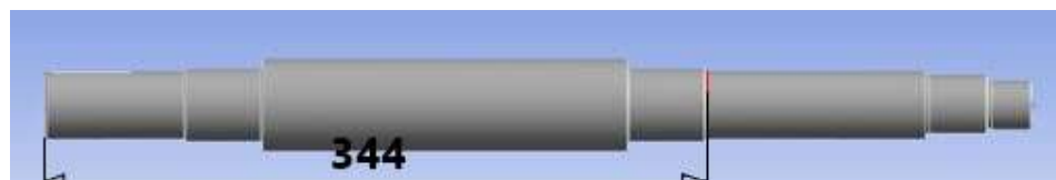
Slika 48. Pozicija pukotine II. [12]
