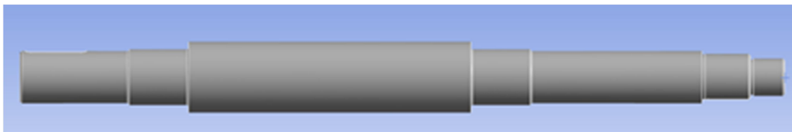
Slika 39. Vratilo pumpe za analizu u Ansys-u. [12]
