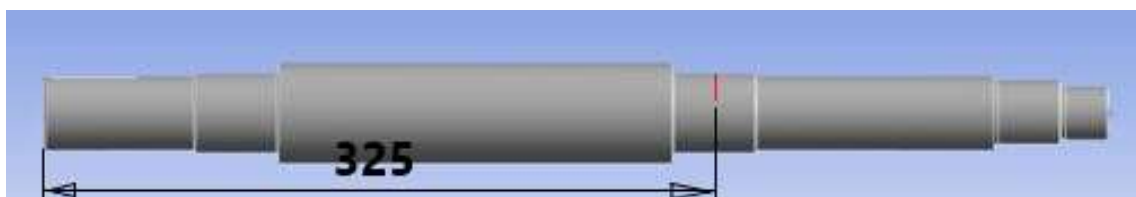
Slika 43. Pozicija pukotine I. [12]
