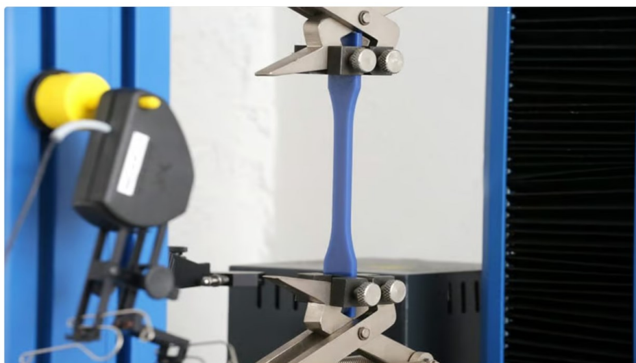
Slika 39. Prikaz ispitne epruvete na kidalici [11].
