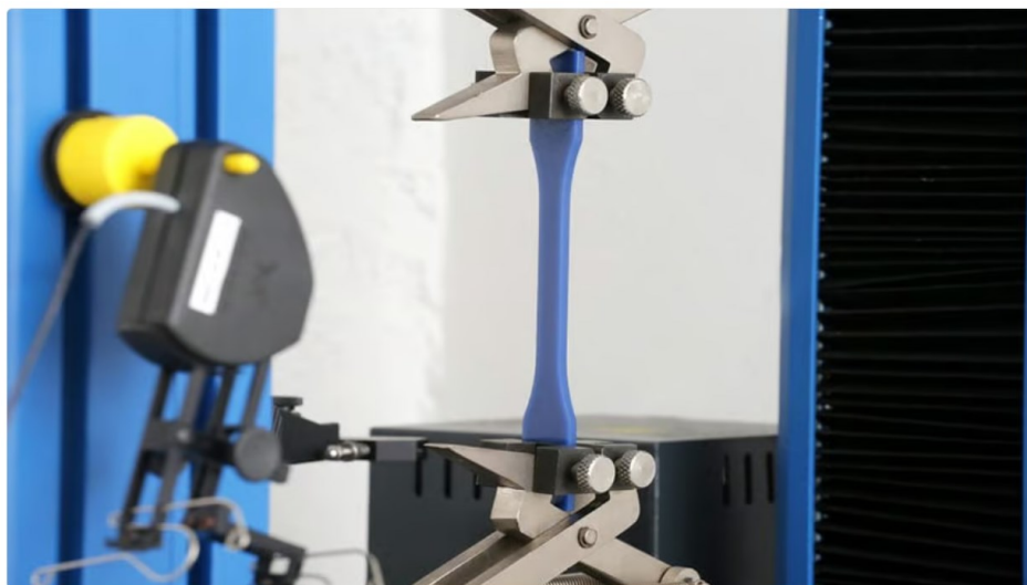
Slika 39. Prikaz ispitne epruvete na kidalici [11].
