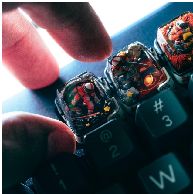
Slika 3. Primjer 3D printanih tipki [24].
