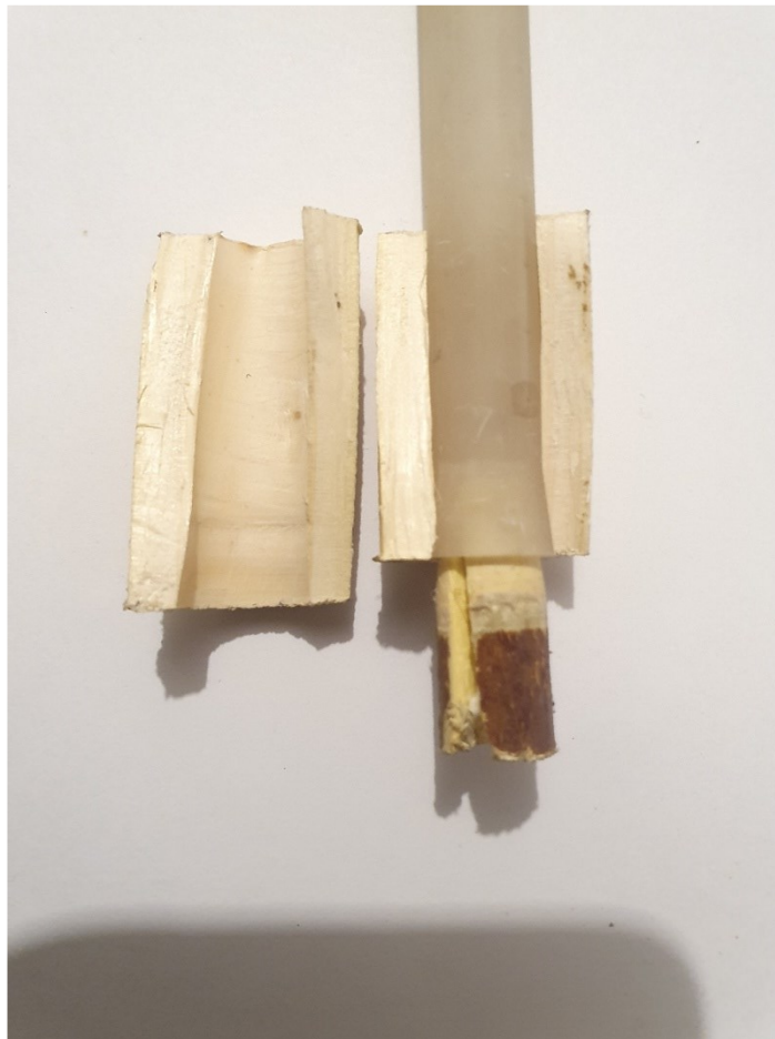
Slika 48. Prikaz umetnutog čepa i obloge na krajevima epruvete.
