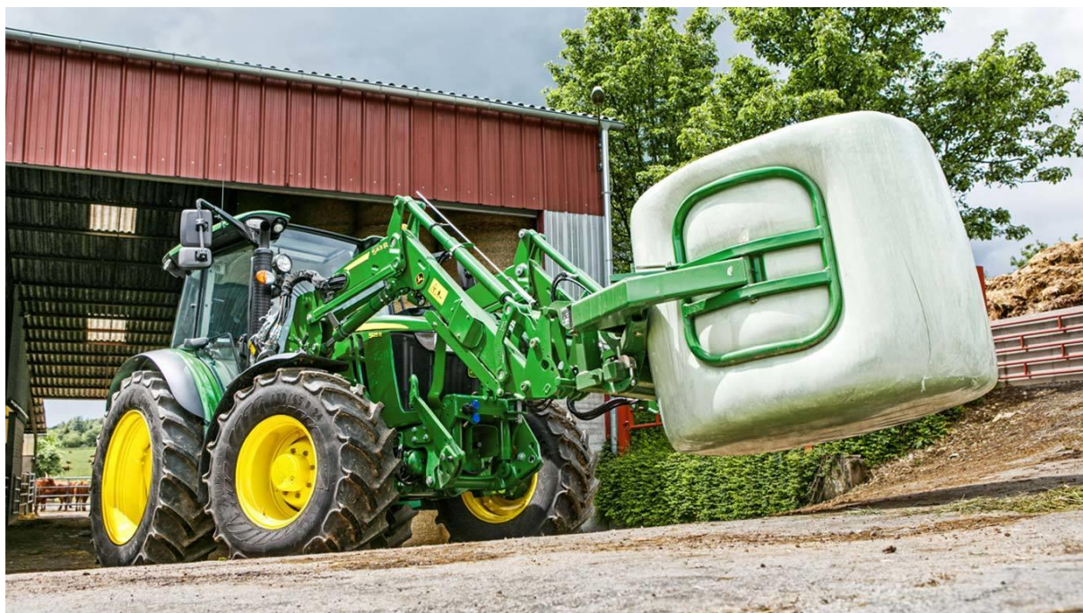
Slika 2. Primjer utovara okrugle bale sjenaže s prednjim utovarivačem [12]
