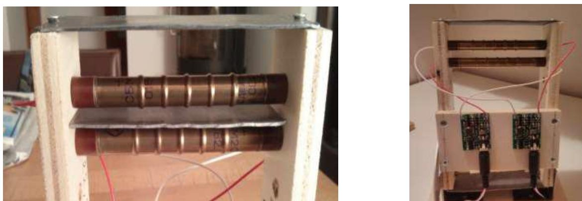
Slika 40. Geigerove cijevi (lijevo); Senzori (desno), amaterski model
