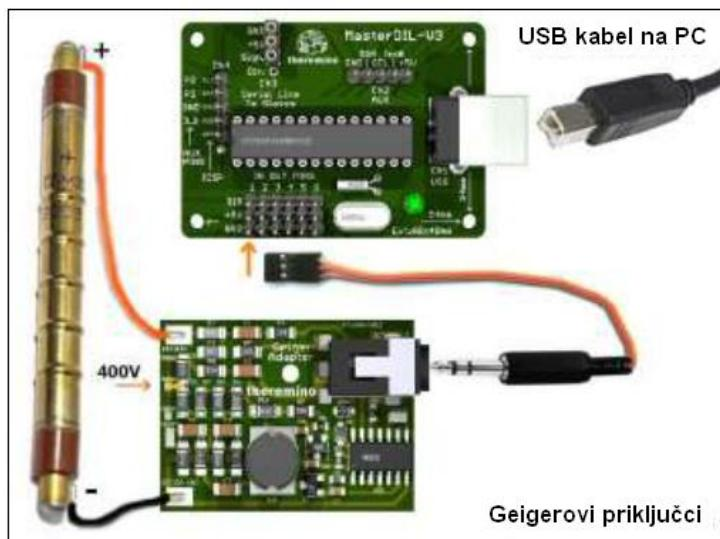
Slika 41. Hardver detektora i povezivanje sa računalom
