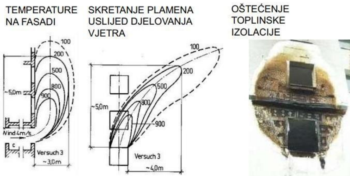
Slika 6. Temperature i trag čađavog vijenca [9]
