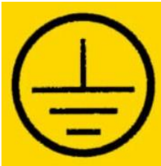
Slika 27. Znak za uzemljenje [20]
