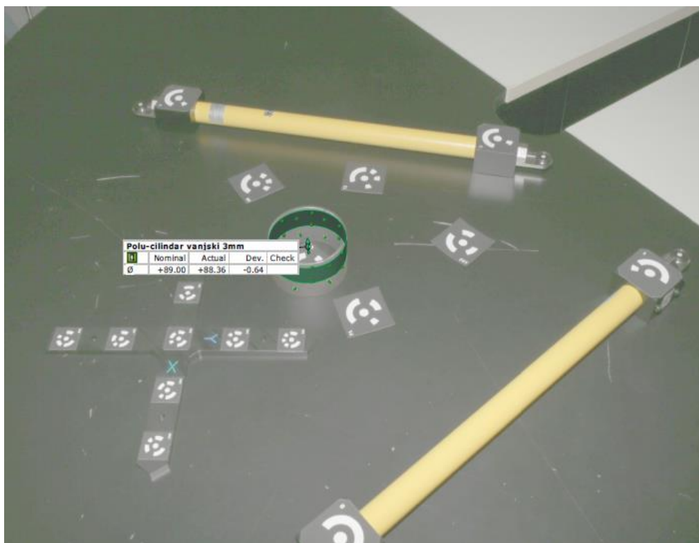
Slika 41. Prikaz cilindričnosti sa točkama od 3mm
