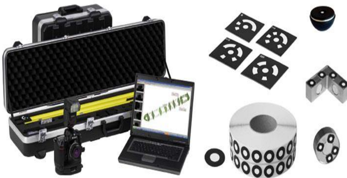
Slika 19. Oprema za fotogrametriju Tritop
