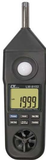
Slika 11. Uređaj za mjerenje fizikalnih čimbenika radnog okoliša [17]
