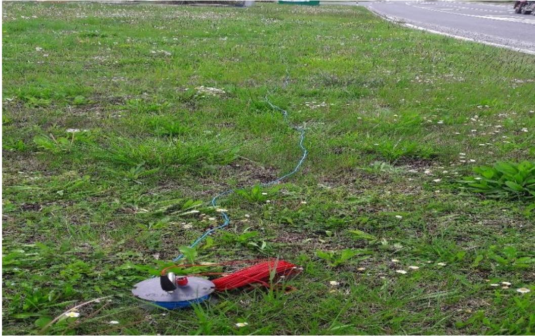
Slika 22. Sonde zabijene u tlo zbog ispitivanja gromobrana [26]
