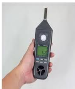
Slika 17. Uređaj za mjerenje jačine zvuka [17]
