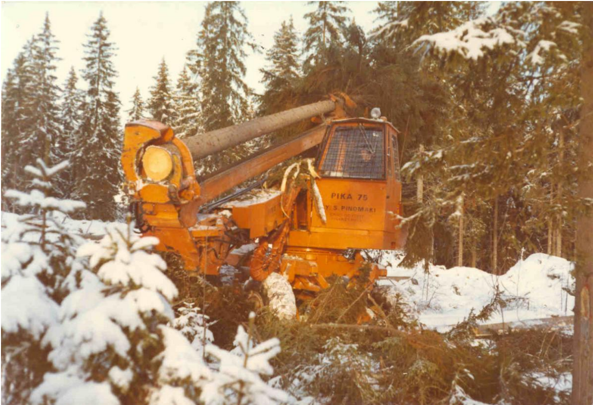
Slika 4. – Prvi harvester, model PIKA 75
