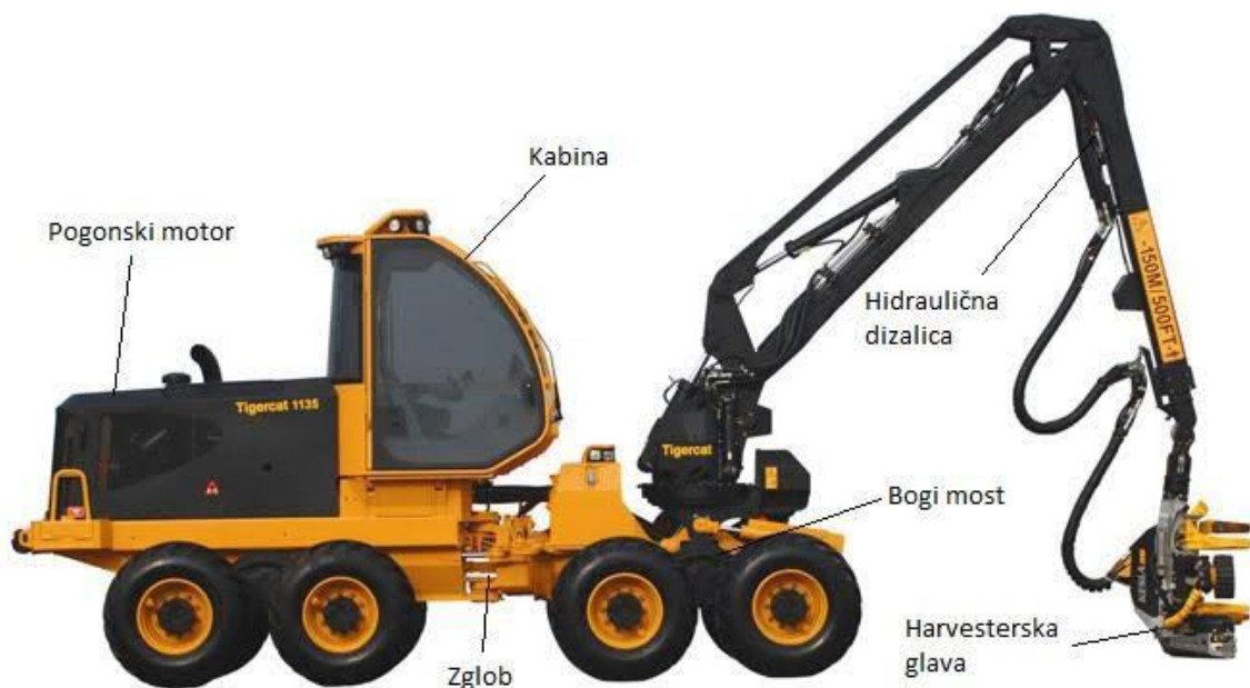
Slika 6. – Prikaz osnovnih dijelova harvestera
