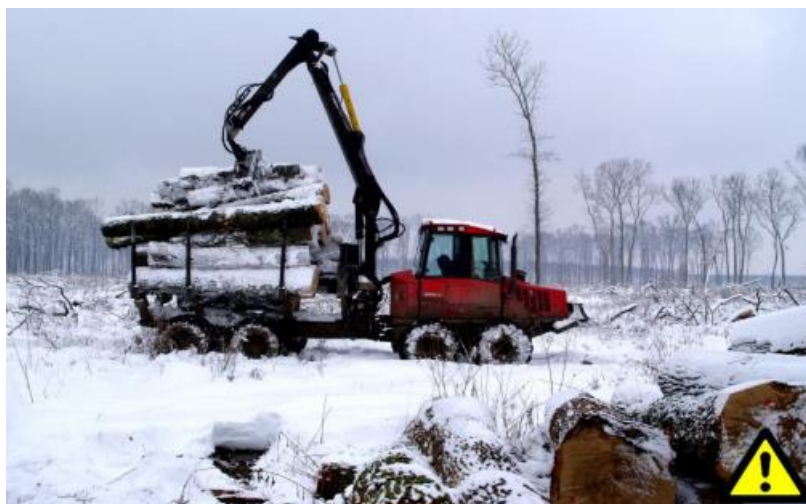
Slika 11. – nepravilno utovaren forwarder
