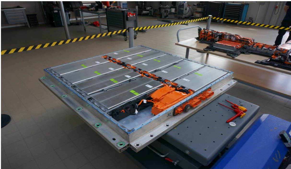
Slika 9. Demontaža li-ion baterije iz električnog automobila
