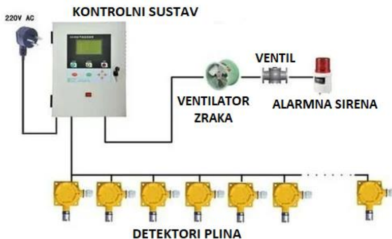
Slika 18. Predodžba alarmnog sustava za detekciju plina [41].
