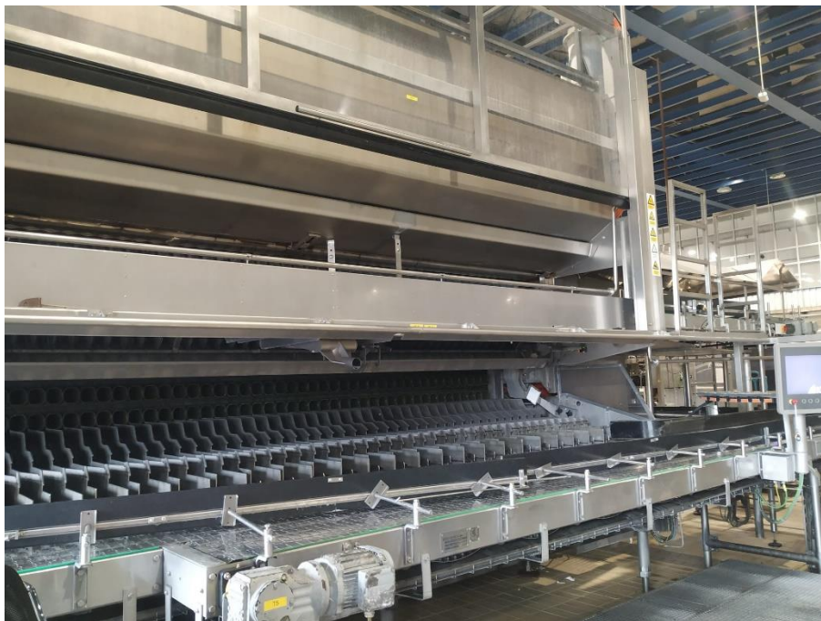
Slika 7. Stroj za pranje boca sa centralnom upravljačkom jedinicom
