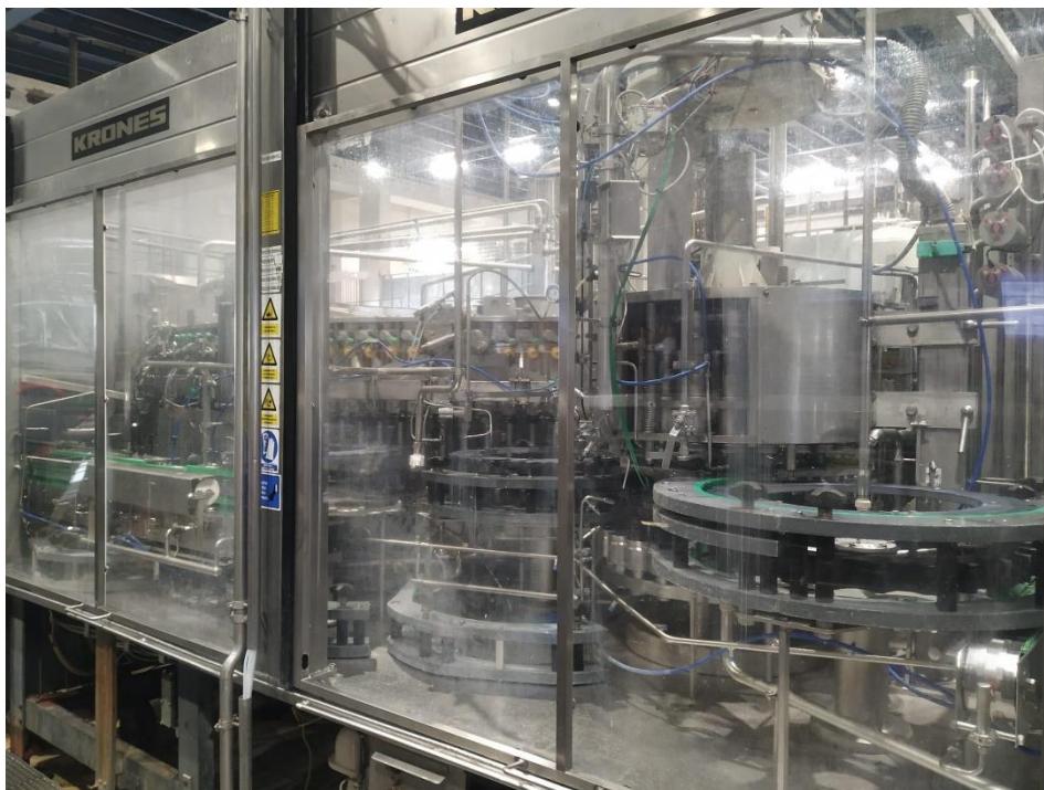
Slika 21. Plastična, prozirna zaštita na stroju za punjenje boca
