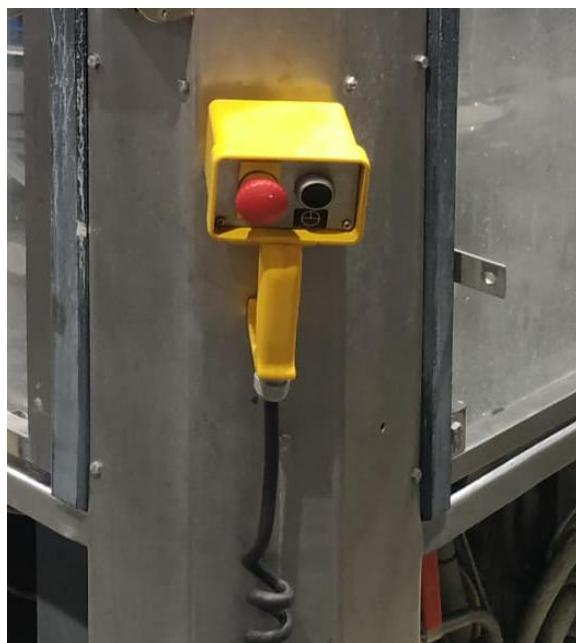
Slika 17. Mobilni upravljač stroja s prekidačem u slučaju nužde
