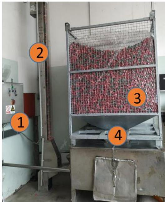
Slika 13. Spremnik krunkih čepova, vodilica čepova i centralna upravljačka jedinica
