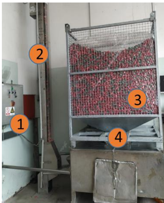
Slika 13. Spremnik krunskih čepova, vodilica čepova i centralna upravljačka jedinica
