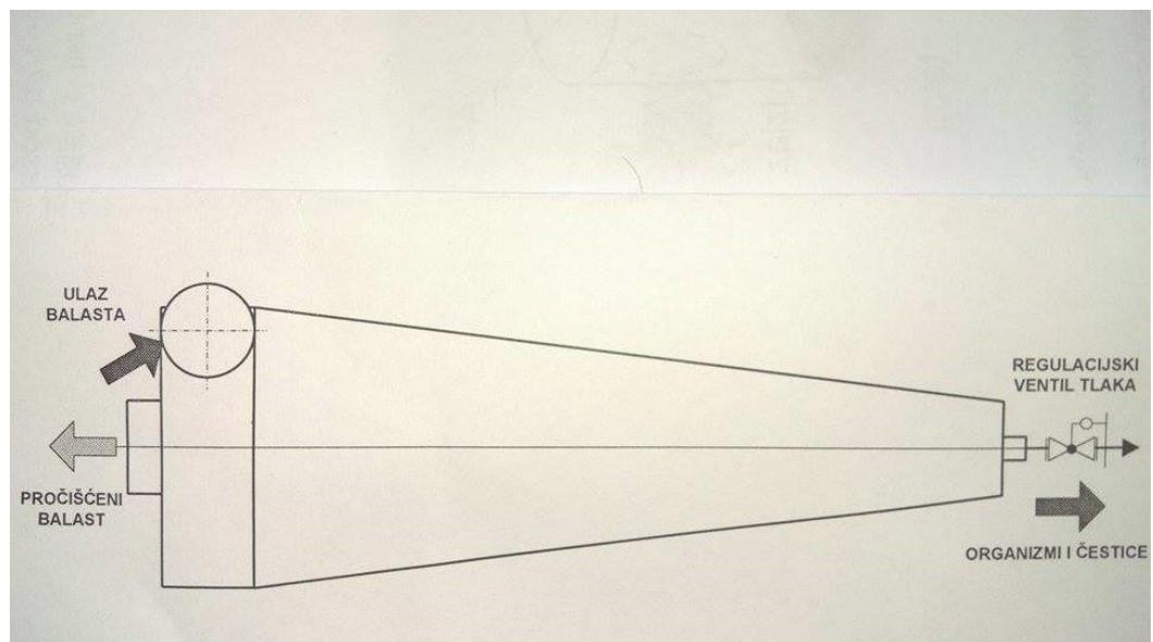
Slika 14. Hidrociklonski separator za pročišćavanje balastne vode
