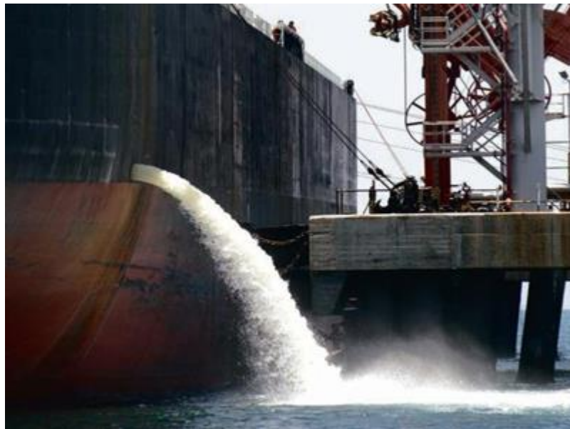
Slika 2. Prikaz iskrcaja balastne vode u luci
