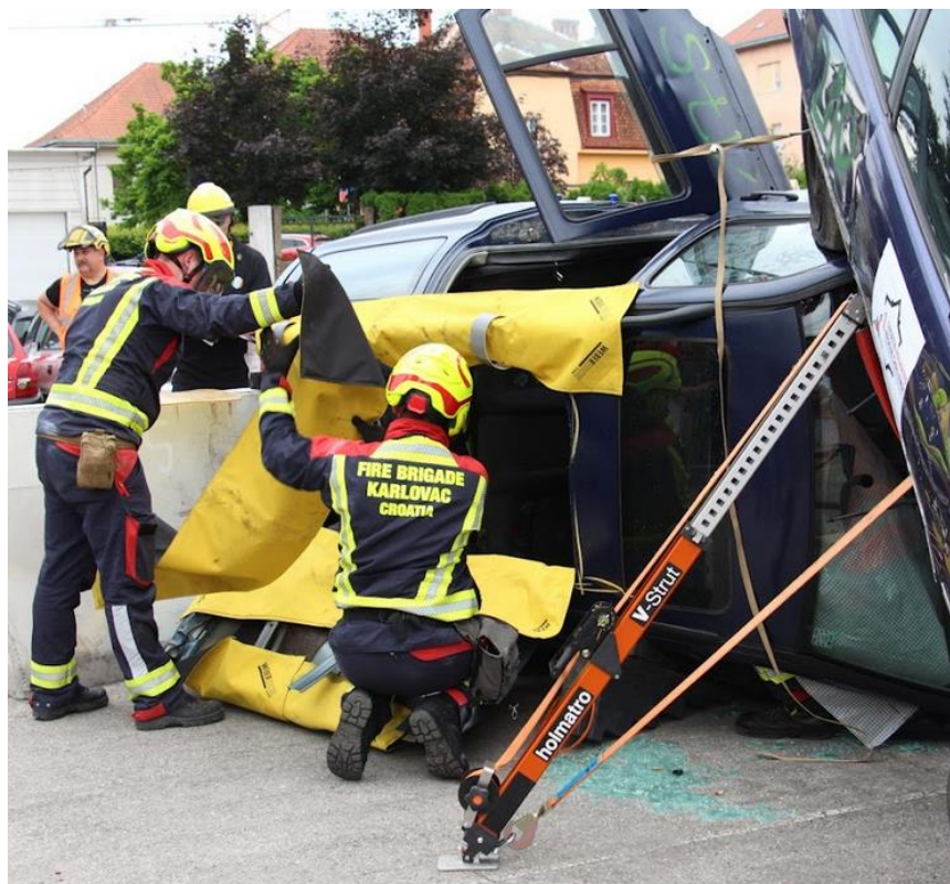
Slika 13. Izrada prostora za spašavanje [3]
