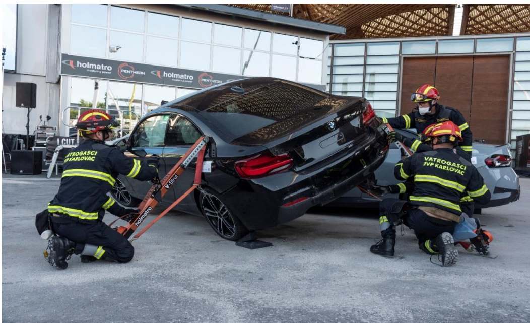
Slika 8. Stabilizacija vozila mehaničkim podupiračima [3]
