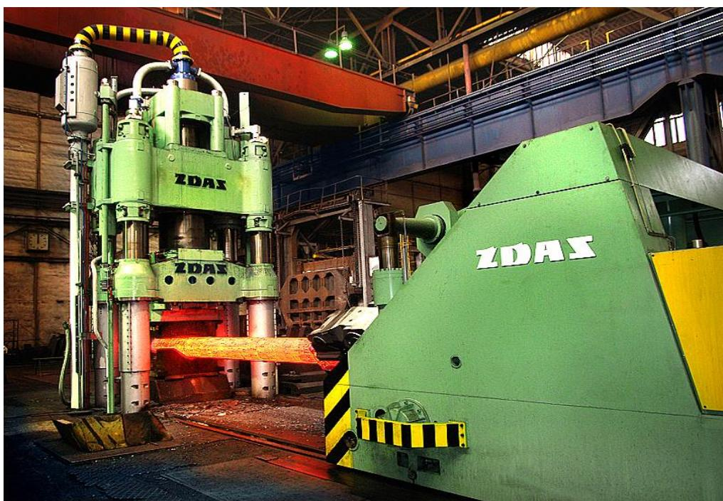
Slika 7. Hidraulička kovačka preša [11]
