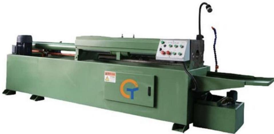
Slika 10. Horizontalni kovački stroj [12]
