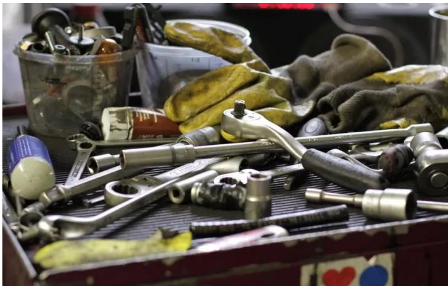
Slika 19. Neispravno odlaganje alata [9]
