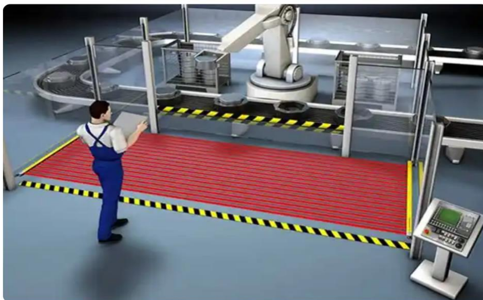
Slika 15. Zaštitni uređaj - svjetlosna barijera [5]
