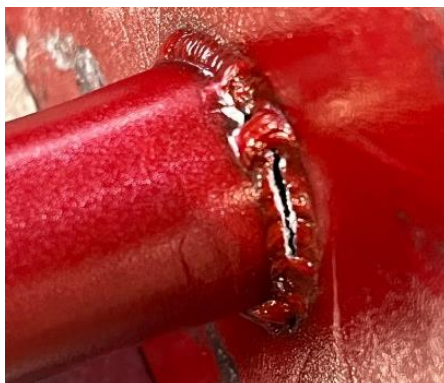
Slika 26. Kritična točka - mjesto zavara
