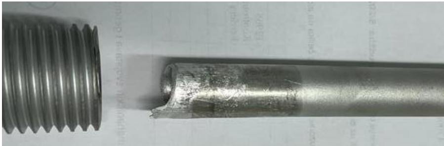
Slika 12. Puknuće ispitnog uzorka
