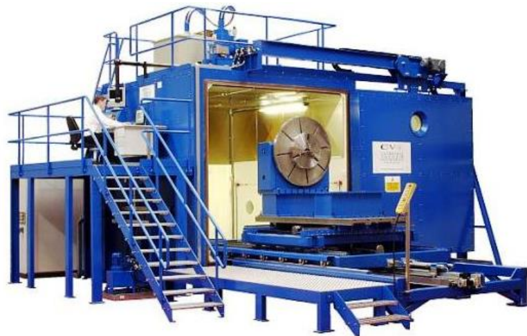
Slika 4. Komora za zavarivanje elektronskim snopom [6]
