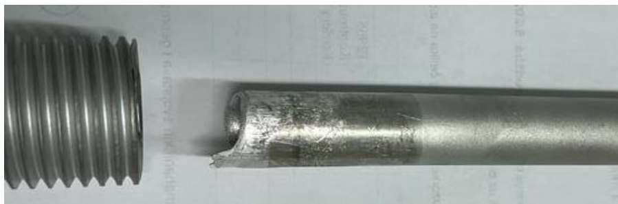
Slika 12. Puknuće ispitnog uzorka
