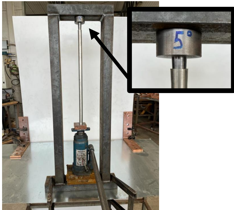
Slika 18. Utiskivanje konusne jezgre u cijev
