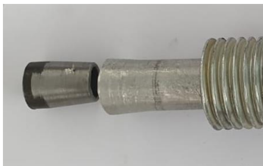
Slika 9. Umetanje čeličnog konusa u cijev
