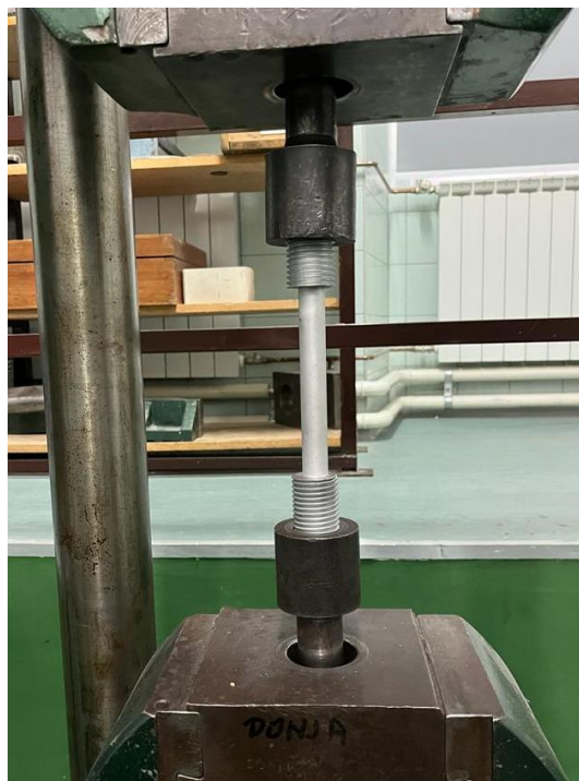
Slika 11. Prihvat uzorka na kidalici
