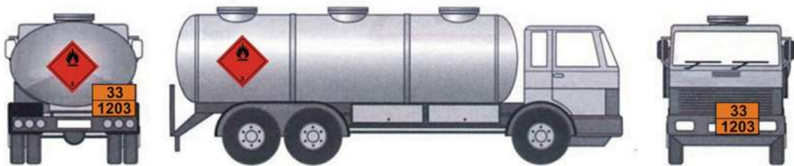
Slika 28. Označavanje vozila za transport zapaljivih tekućina
