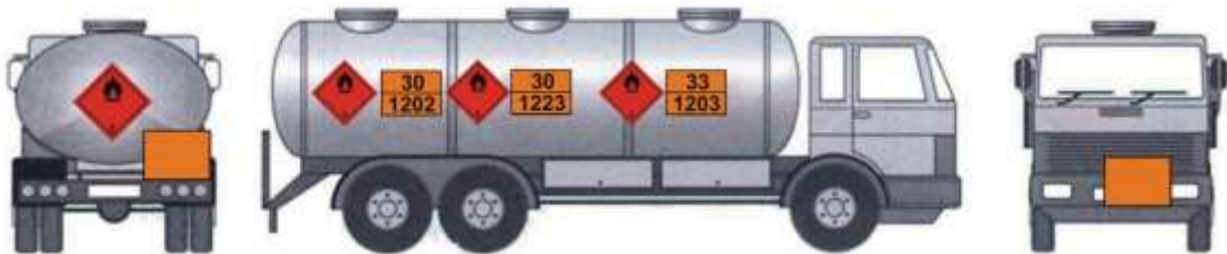
Slika 27. Osnovni način obilježavanja cisterne
