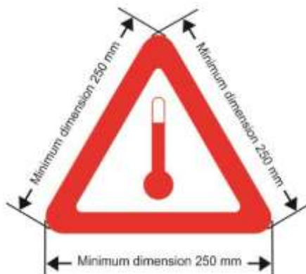
Slika 26. Oznaka opasne tvari s povišenom temperaturom
