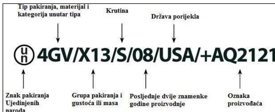
Slika 15. Primjer kodnog broja na pakiranju i značenje svake cjeline
