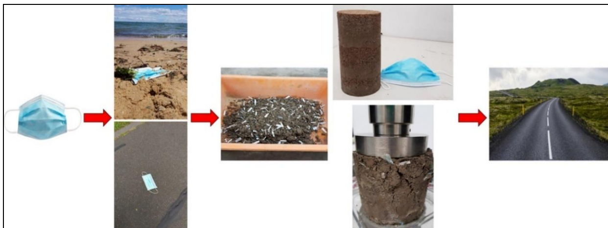
Slika 20. Upotreba maski za lice za proizvodnju cestovnih baza i zastora [51]
