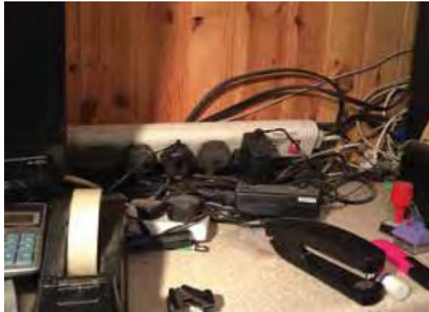
Sl. 3. Preopterećenost prijenosnika električne energije [3]
