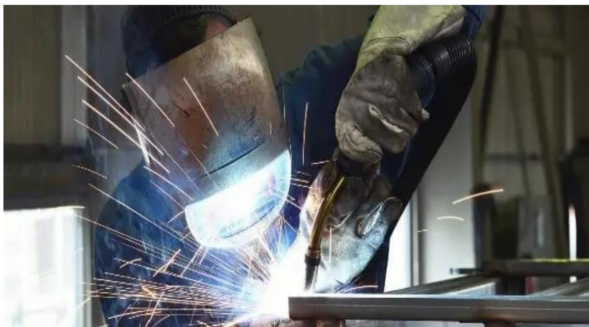
Slika 3. Intenzitet zračenja električnog luka pri zavarivanju
