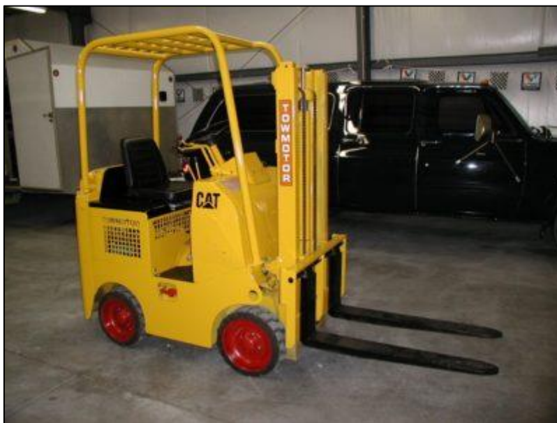
Sl. 5. Towmotor iz 1966. koji ima nadglavnu zaštitu vozača
