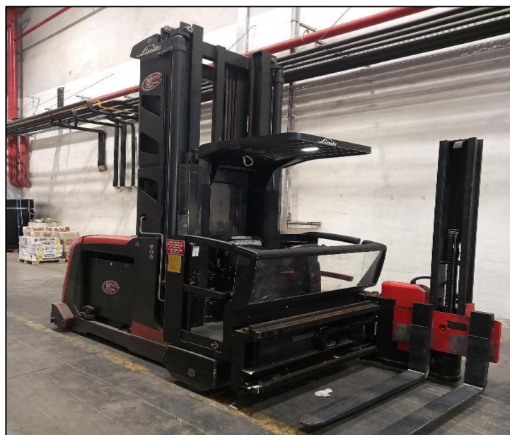
Sl. 8. Bočni viličar tvrtke Linde
