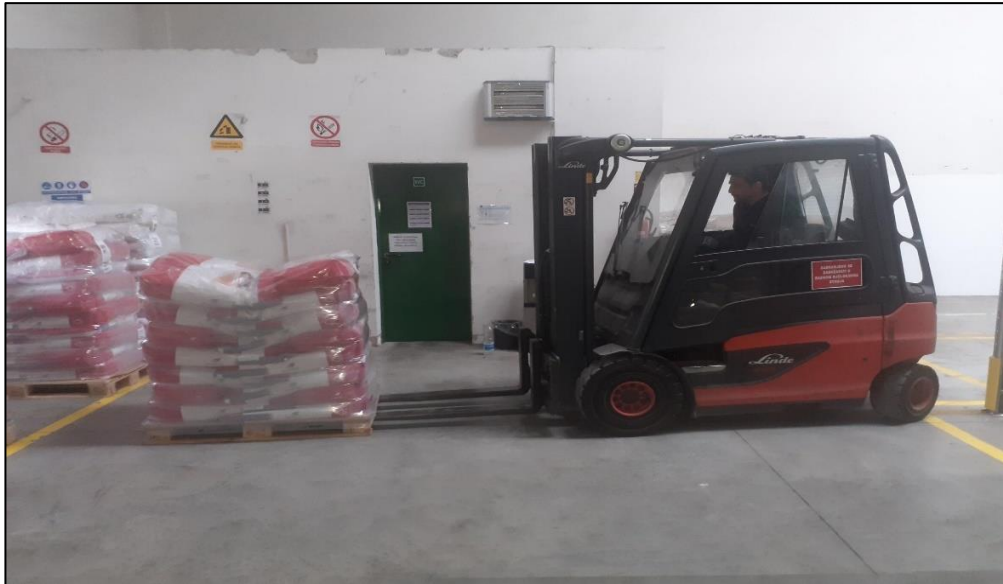
Sl. 27. Ispravan pristup teretu
