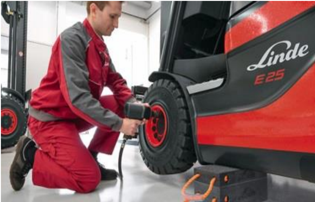
Slika 34. Sigurna zamjena guma na viličaru
