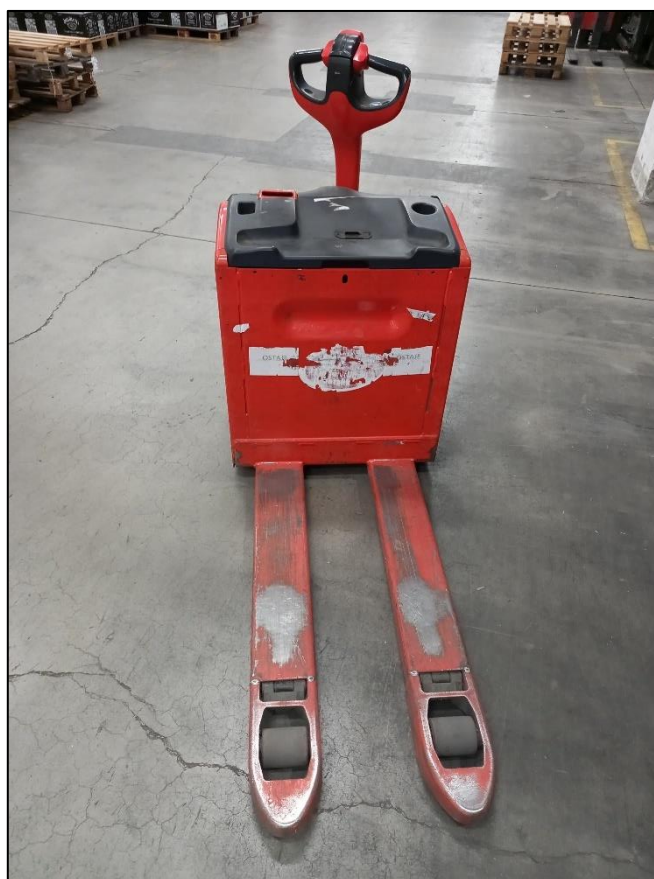
Sl. 9. Niskopodizni viličar
