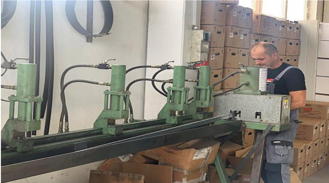
Slika 40. Stroj za bušenje rupa za harmonika vrata
