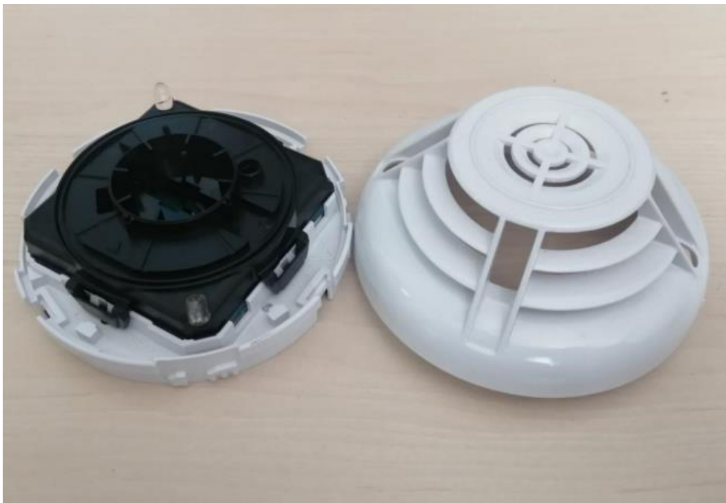
Slika 8. Termomaksimalni javljač požara [11]
