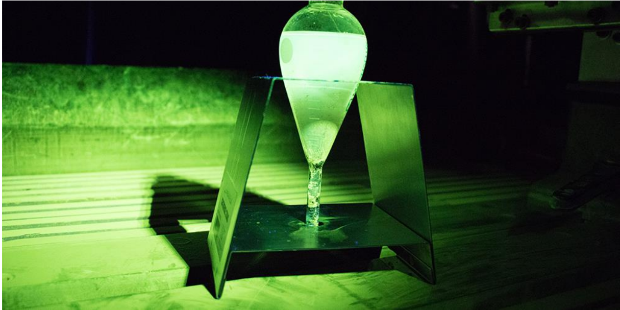
Slika 30. Provjera čistoće magnetnih čestica [11]
