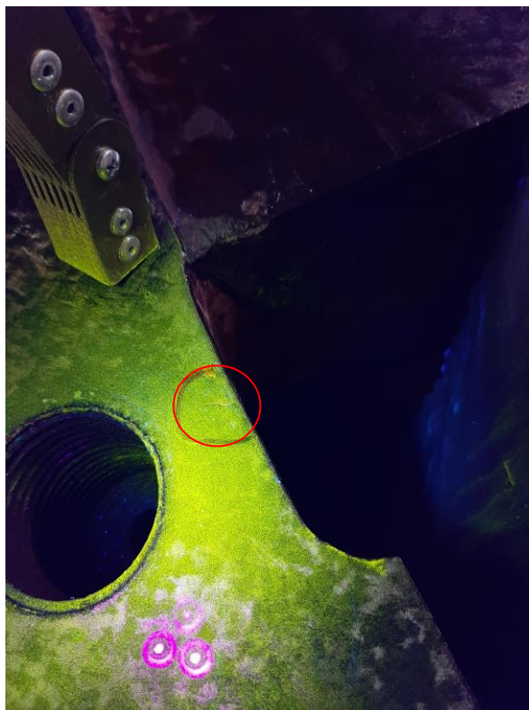
Indikacije na dosjednoj plohi VT dijela
