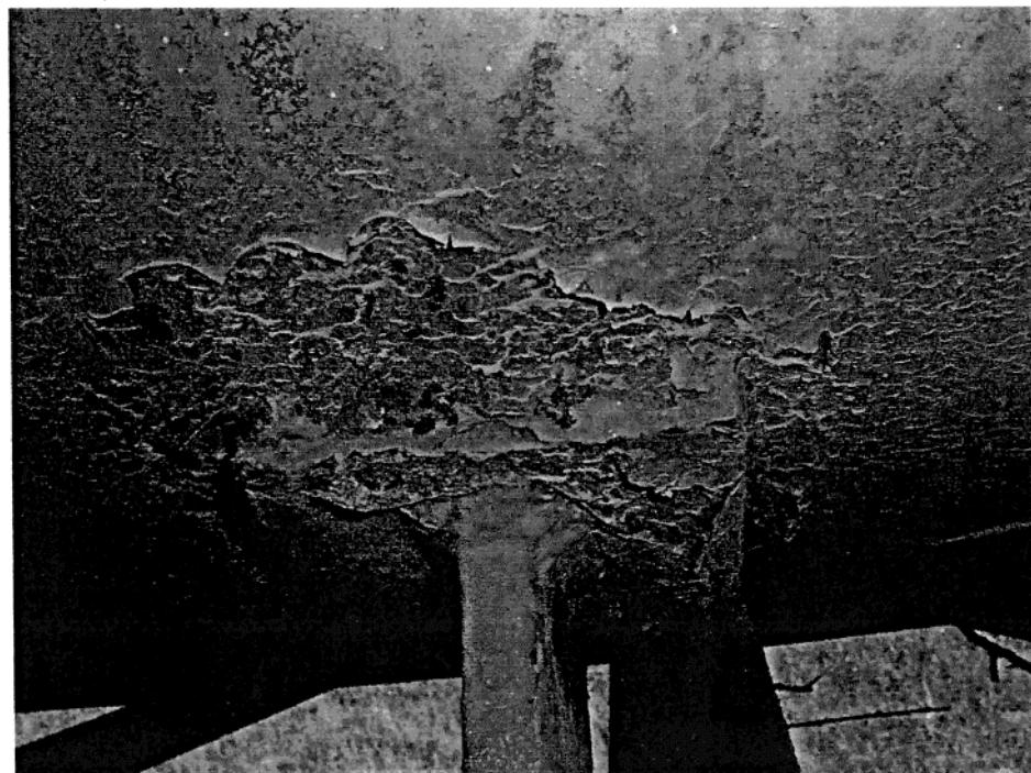
**Slika 14. Oštećenje zaštitnog premaza i korozija oko zavarenog spoja**
