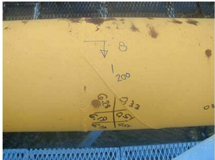
Slika 19. Označavanje rezultata mjerena na mjernom presjeku 200
