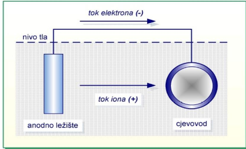
**Slika 6. Shema sustava katode zaštite sa žrtvenim anodama**
