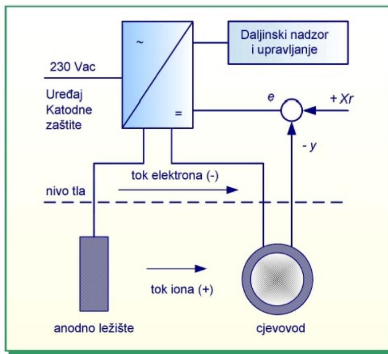
**Slika 7. Sustav katode zaštite sa vanjskim izvorom struje**
