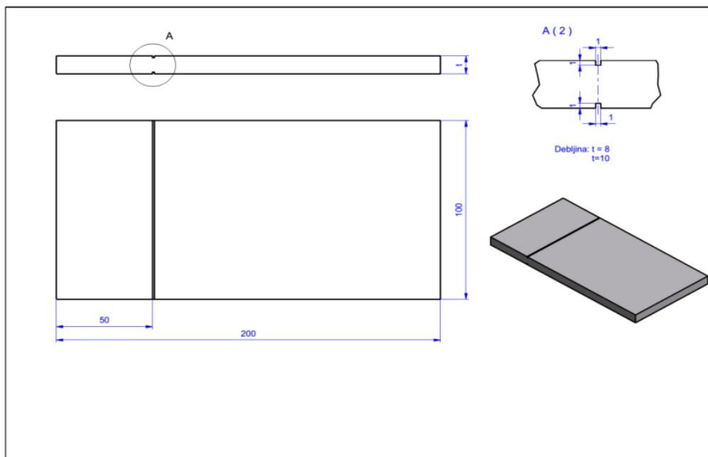
**Slika 26. Baždarni blok za podešavanje osjetljivosti ispitivanja**
