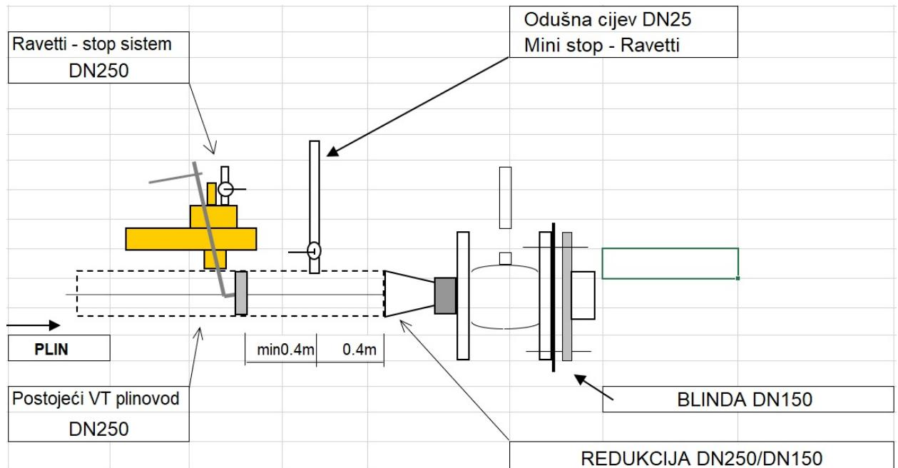
**Slika 4. Kuglasta slavina – VT i Ravetti naprava**
