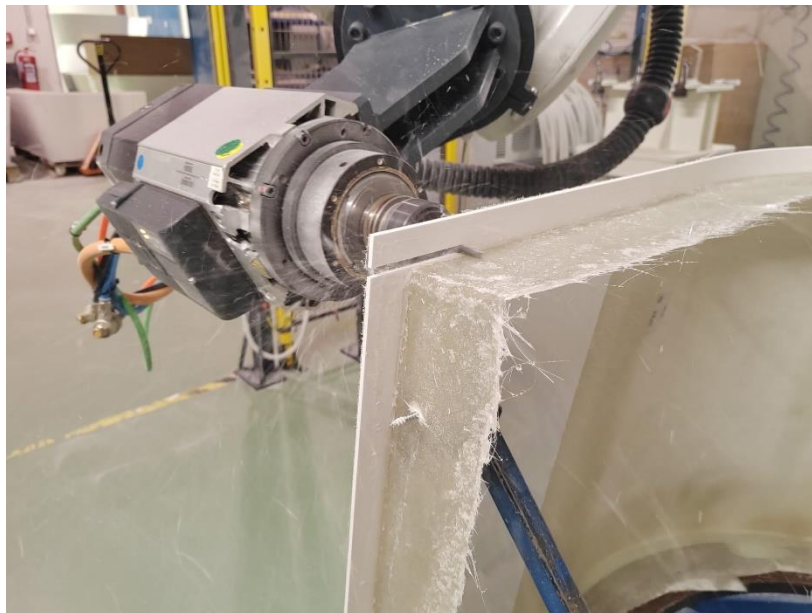
Slika 7. Proces robotskog obrezivanja obloge.
