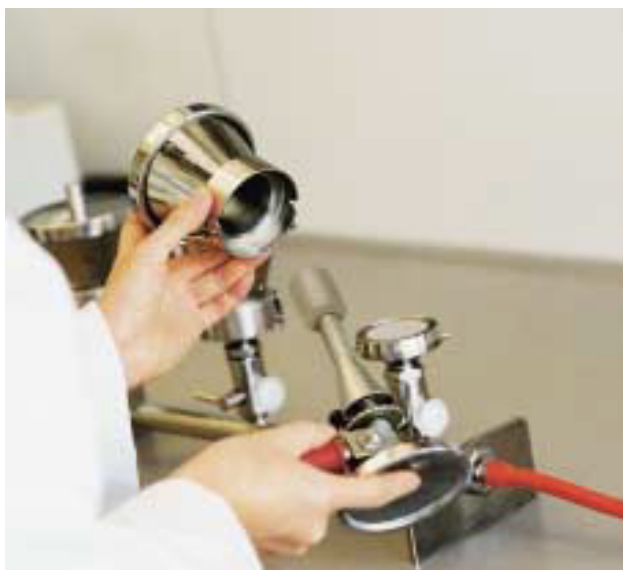
Slika 3. Sterilizacija metalnih dijelova membranskog filtra (Sartorius, 2015).
