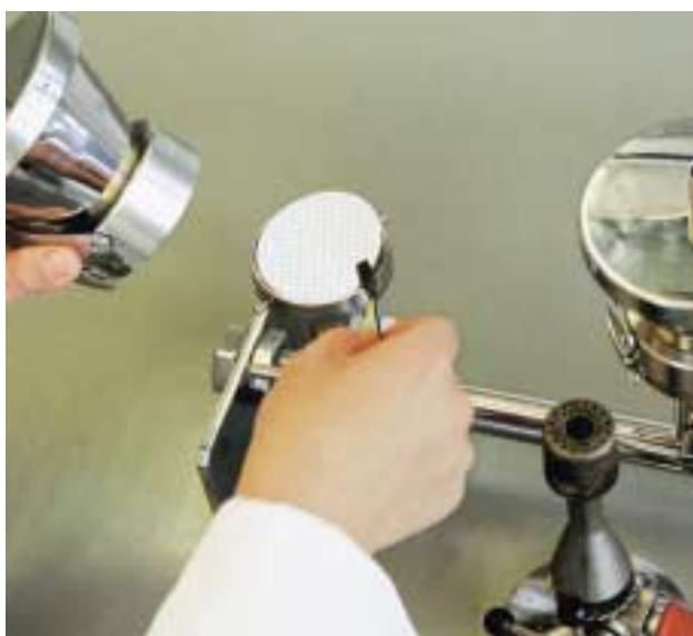
Slika 4. Postavljanje membrane na poroznu rešetku membranskog filtra (Sartorius, 2015).
