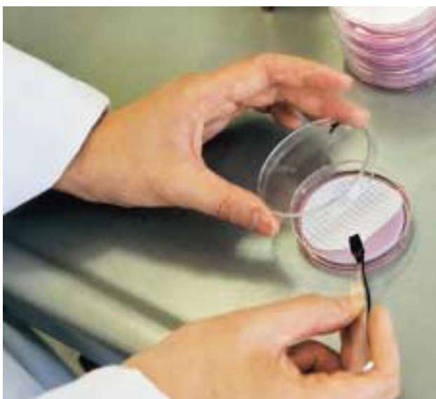
Slika 6. Nacjepljivanje membranskog filtra na petrijevu zdjelicu (Sartorius, 2015).
