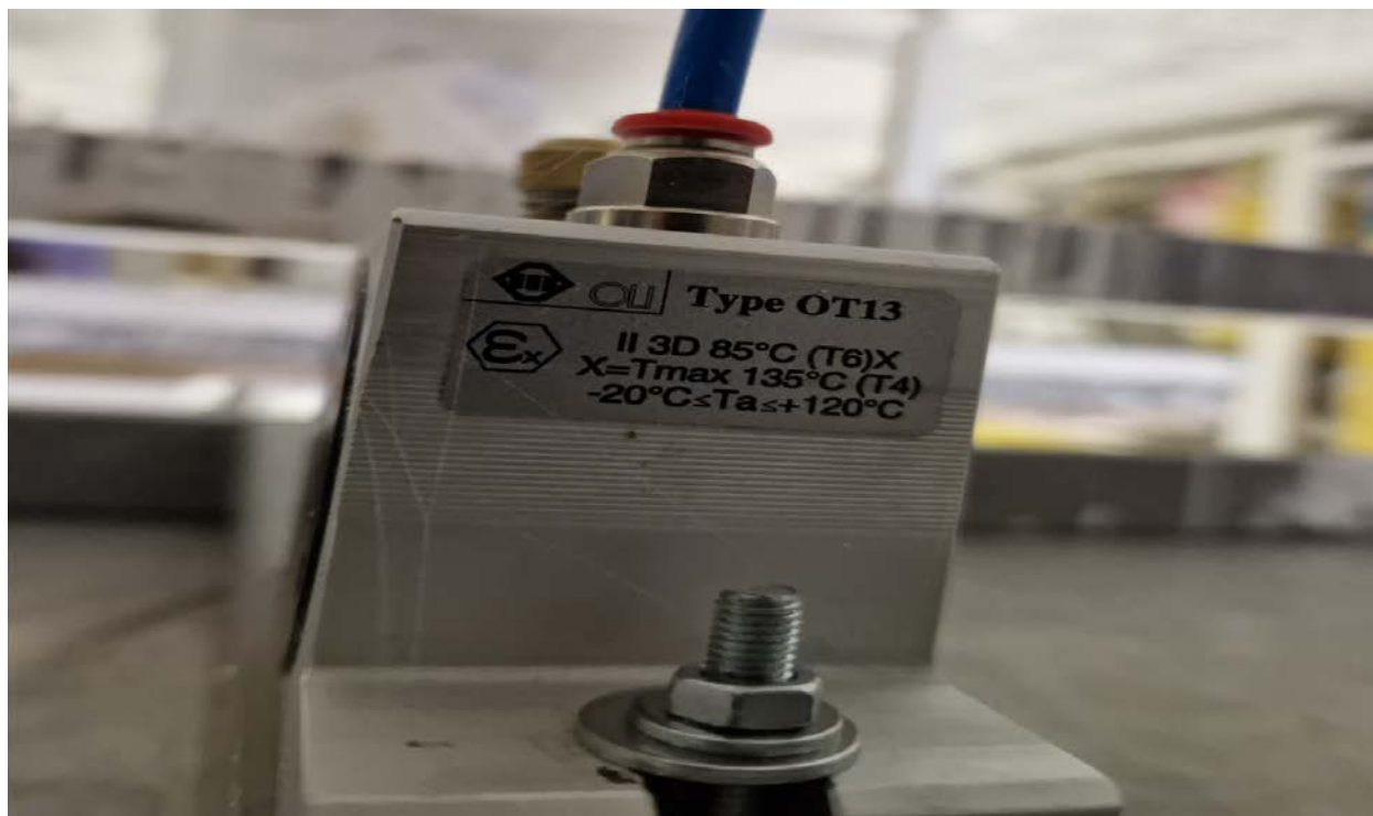
Slika 12 Vibroalat koji se nalazi ispod vibro-stola (vlastiti izvor)
