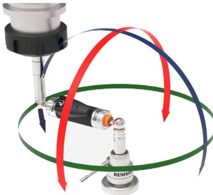
Slika 39. Shematski prikaz rada QC20 – W [10]
