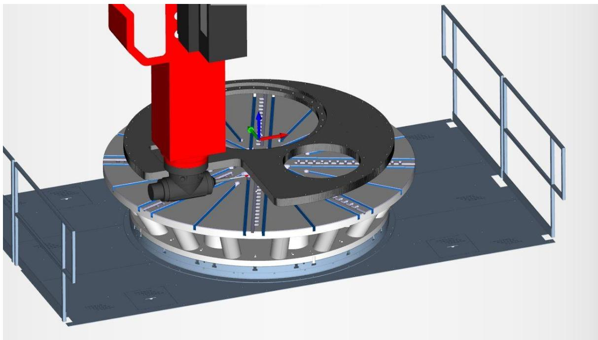
Slika 25. Bušenje četvero-osnom glavom na obradnom centru
