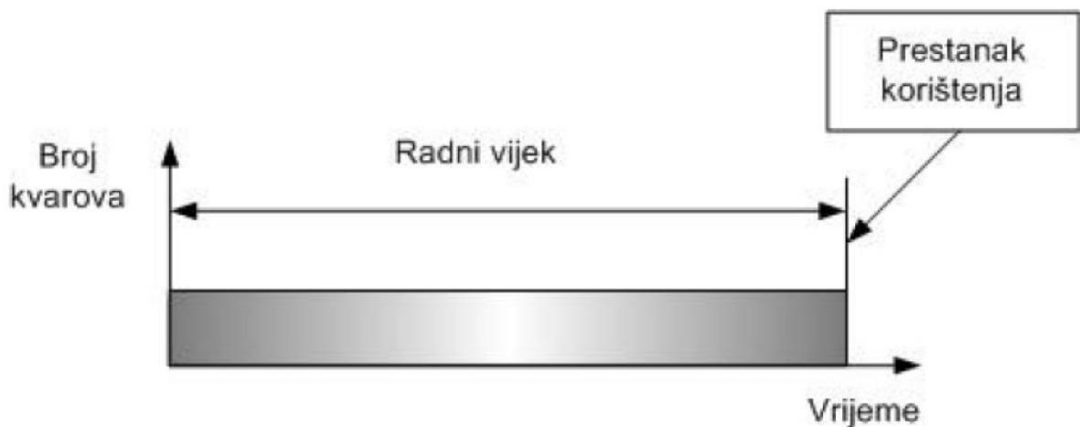
Slika 6. Stalni kvarovi [1]
