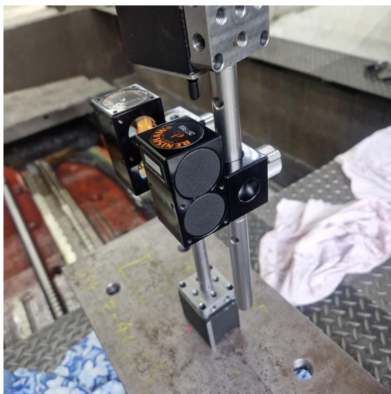
Slika 61. Interferometri montirani na vretenište i „X“ os
