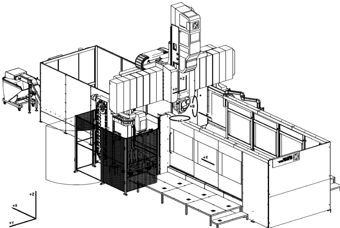
Slika 9. Tokarsko glodači obradni centar [5]
