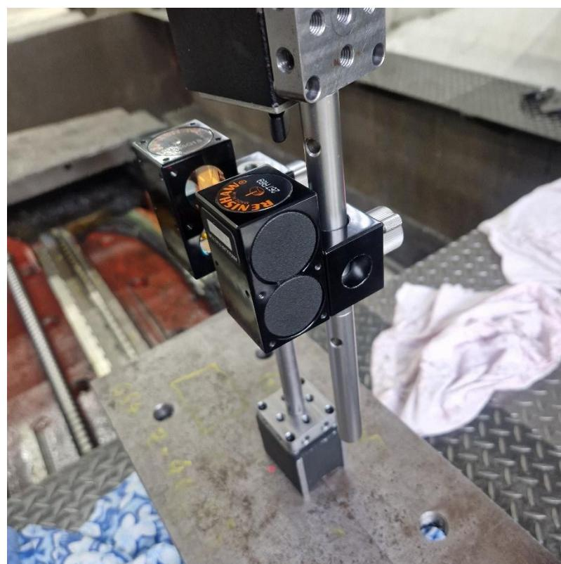
Slika 61. Interferometri montirani na vretenište i „X“ os
