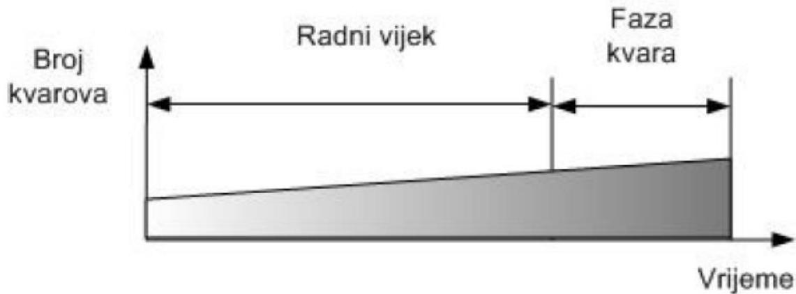
Slika 4. Progresivni kvarovi [1]
