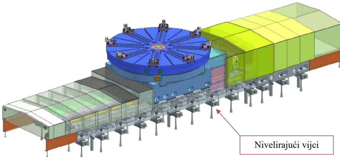
Slika 43. Sklop „X“ osi obradnog centra [5]
