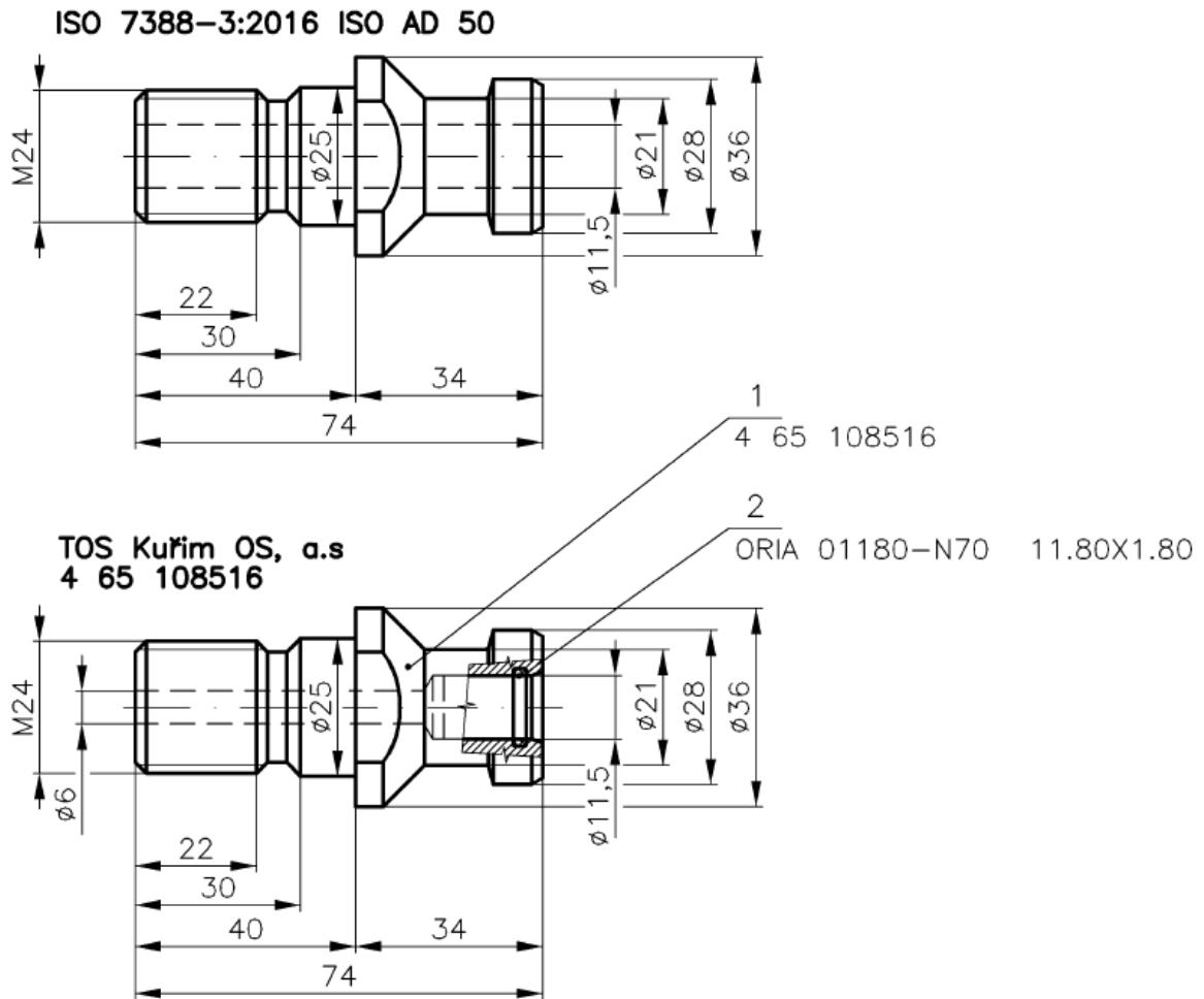
Slika 12. Povlačni vijak prema ISO 7388-3:2016 [5]
