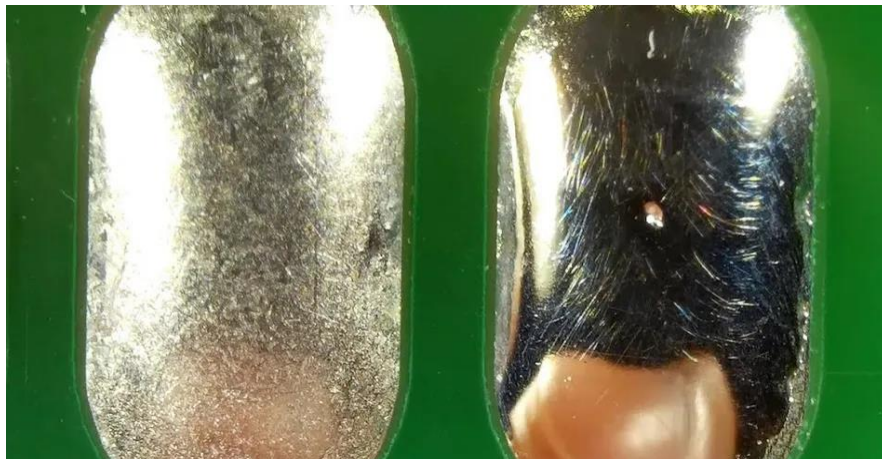
Slika 1: Bezolovni i olovni lem [2]
